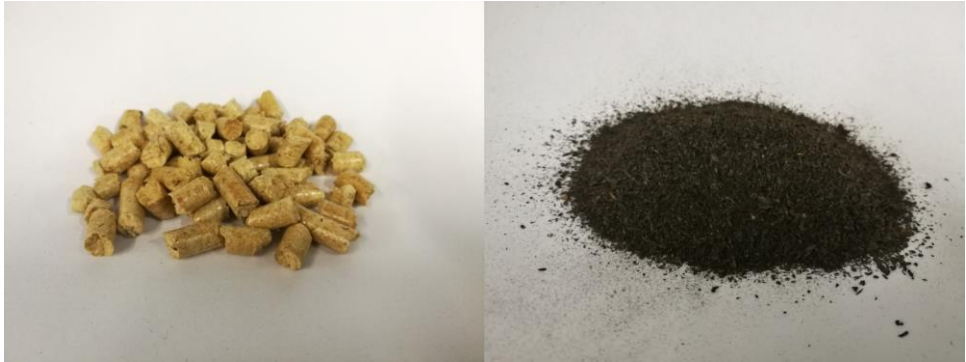
Abbildung 12: Rohe Holzpellets und deren Kohle bei 325 °C
