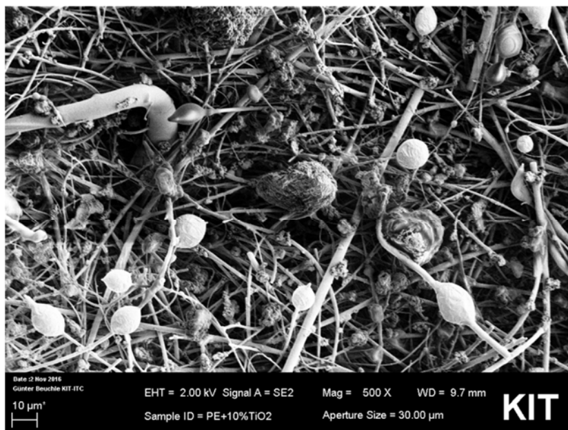
Abb. 24: REM-Aufnahme einer Probe nach der Verbrennung von PE + 10 % TiO 2 .
