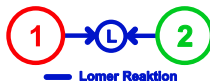
Abbildung 5.16.: Schematische Übersicht der Konfiguration der zwei Gleitsysteme \xi = 1, 2 für die Lomer Reaktionen.
