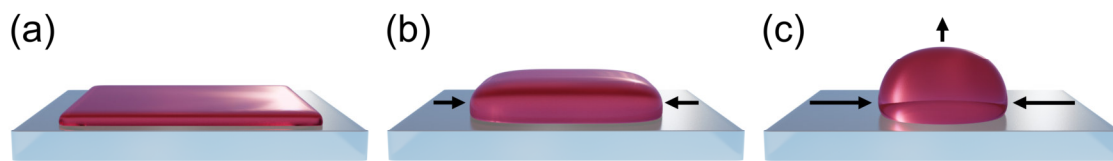
Abbildung 7.1: Ungetrocknetes appliziertes Druckbild auf einem Substrat (a). Sowohl eine niedrige SFE des Substrats, als auch eine große ST der Tinte bewirken, dass sich die Grenzfläche zwischen Substrat und Flüssigkeit reduziert und sich die Tinte vom Substrat entsetzt (b). Je nach Ausprägung ist das ursprüngliche Druckbild nicht mehr zu erkennen und die Tinte zieht sich zu Tropfen zusammen (c).
