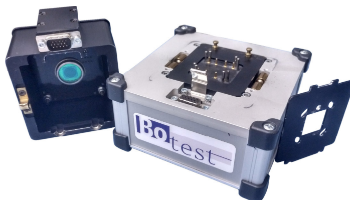
Abbildung 3.15: LIV-Messsystem der Firma Botest bestehend aus Probendeckel mit integrierter Photodiode und Probenhalter mit Probenkontaktierung.
