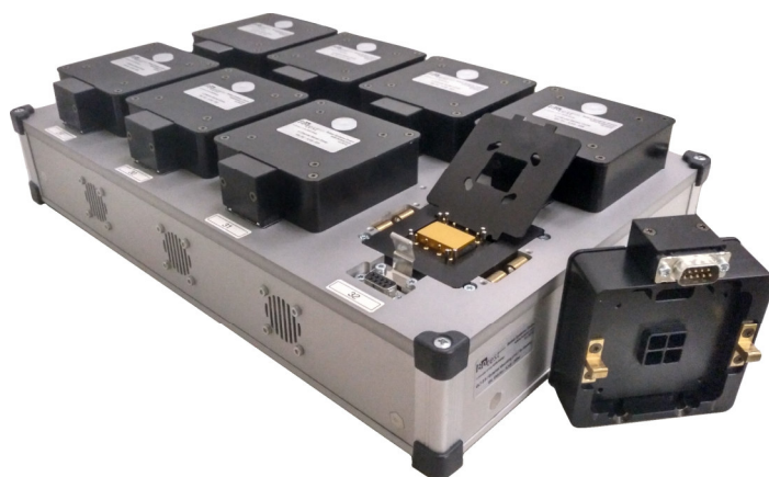
Abbildung 3.16: OLT-Messplatz der Firma Botest . Modul mit acht Probenhaltern, Probendeckeln mit Rot-Grün-Blau-Sensoren und Probenkontaktierung mit integriertem Peltier-Element.
