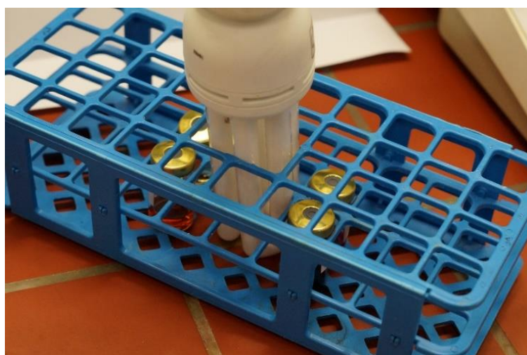
Abbildung 100: Reaktionsaufbau zur Belichtung der Nitrierungs- und Halogenierungsreaktionen unter Verwendung von \text{NOBF}_4 .
