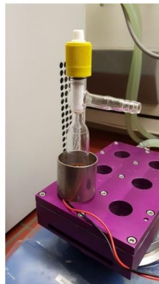
Abbildung 99: Belichtungsapparaturen mit modularem Aufbau zur Durchführung der Belichtungsexperimente. LED-Setup zur Belichtung der Gasreaktionen unter Verwendung von \text{SF}_6 .
