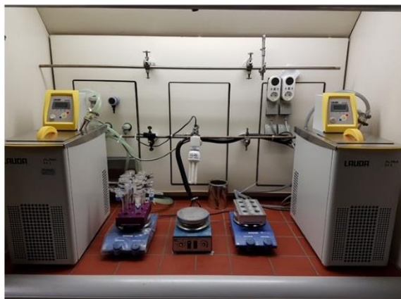
Abbildung 99: Belichtungsapparaturen mit modularem Aufbau zur Durchführung der Belichtungsexperimente. LED-Setup zur Belichtung der Gasreaktionen unter Verwendung von \text{SF}_6 .
