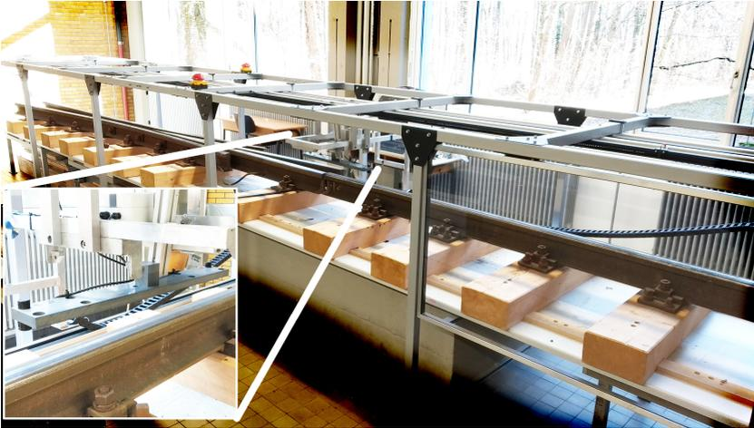
**Abbildung 3.4:** Darstellung des Schienenprüfstandes zusammen mit einer Detailansicht des DIS.
