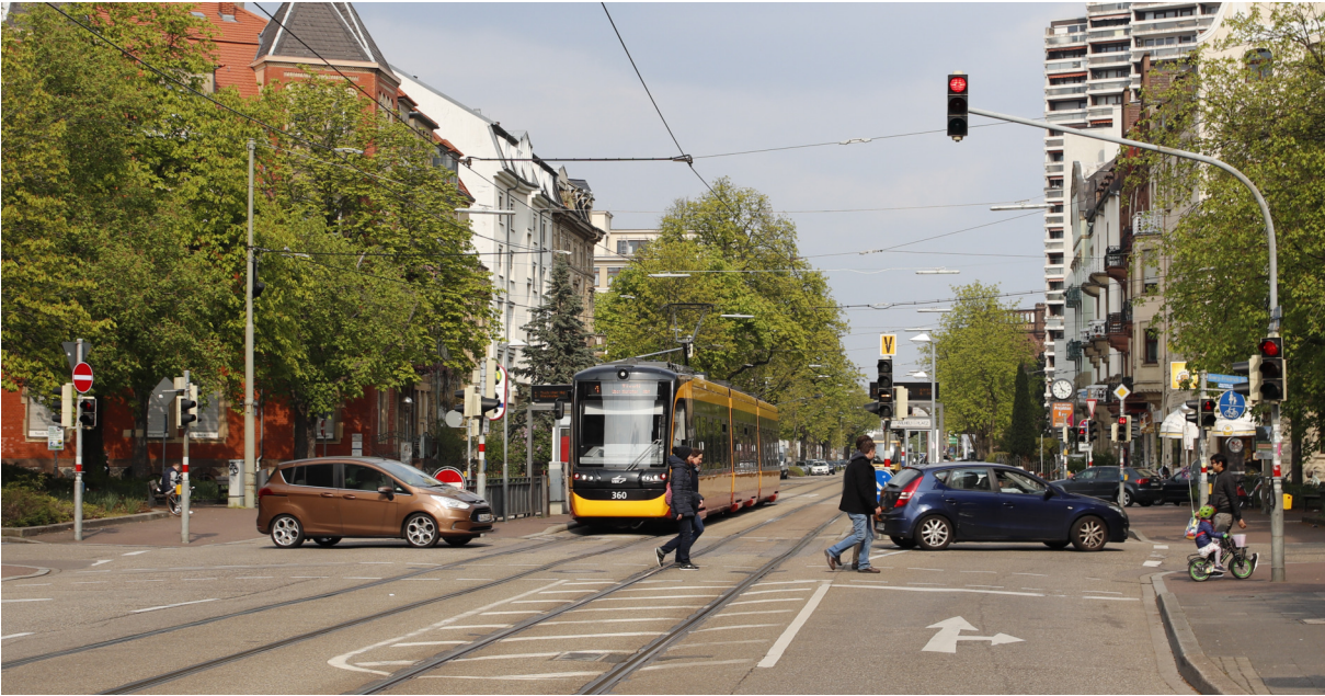
Abbildung 1.1: Situationen wie diese sind eine enorme Herausforderung für automatisierte Fahrzeuge. Um die Situation zu verstehen, müssen Fahrstreifen bestimmt, teilweise verdeckte Verkehrsschilder und Ampeln zugeordnet, sowie mögliche Pfade anderer Verkehrsteilnehmer wie Fußgänger bestimmt werden.
