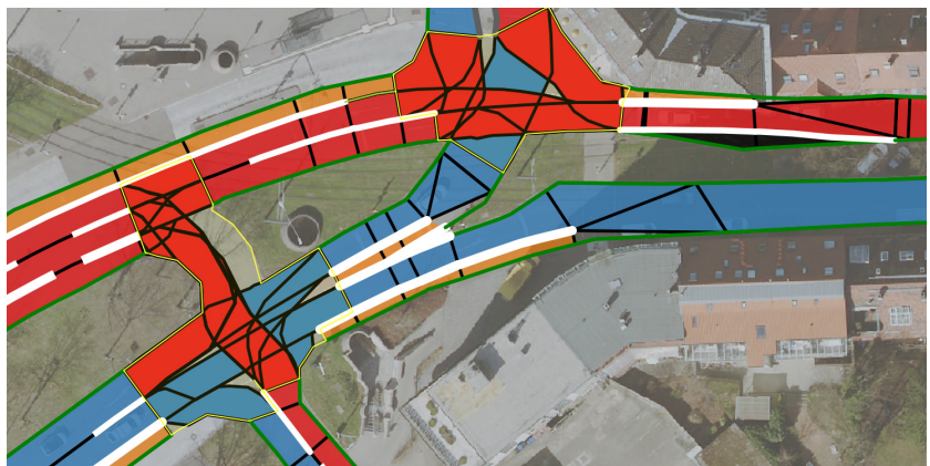
Abbildung 8.7: Ergebnisse aus der Kartengenerierung. Unterschiedliche Fahrrichtungen sind blau, bzw. rot eingefärbt. Violette Fahrstreifen sind bidirektional, nicht befahrbare schwarz. Quelle Luftbilder: Stadt Karlsruhe, Lizenz: dl-de/by-2-0.
