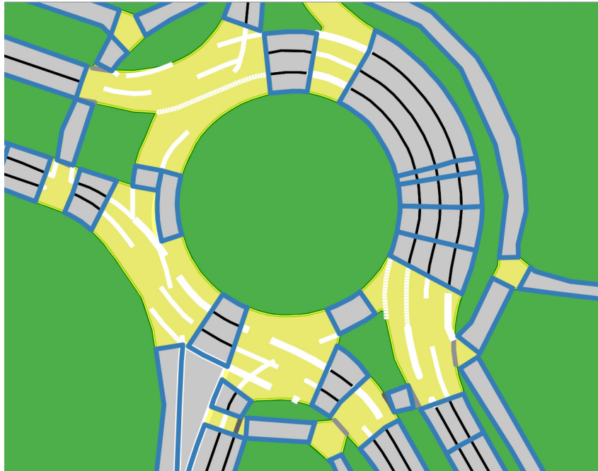
Abbildung 5.4: Ergebnis der Bestimmung der Kreuzungsflächen (gelb). Die Verkehrsstreifensegmente zwischen den Kreuzungen sind durch schwarze Linien gekennzeichnet.
