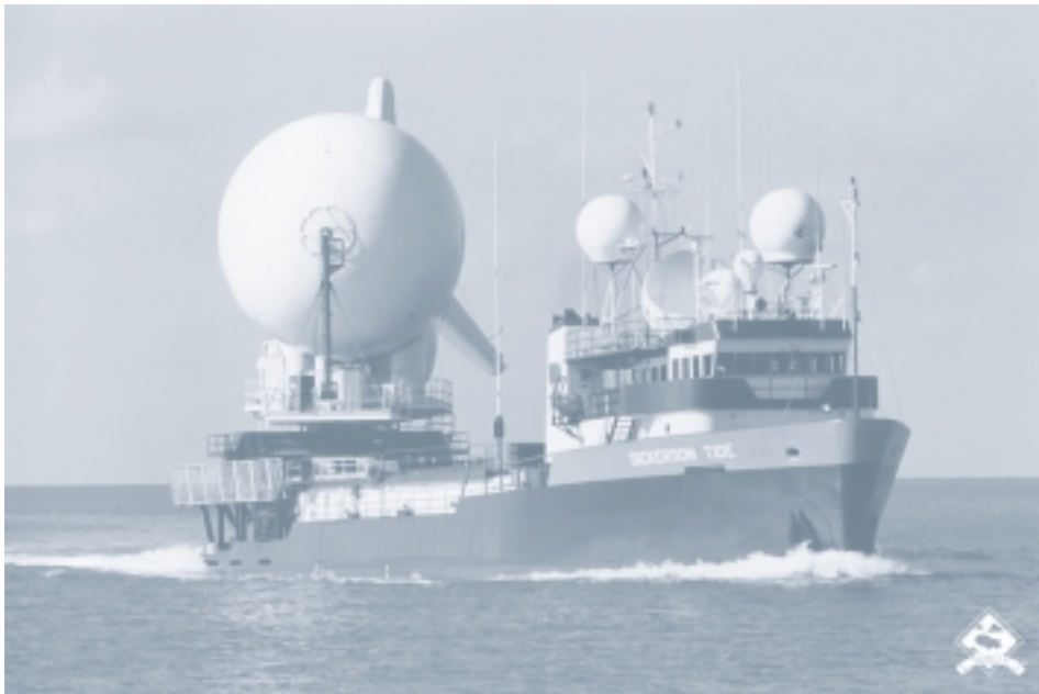
ABB. 4: AEROSTAT (TCOM-32-M) MOBIL AUF EINEM SCHIFF STATIONIERT
