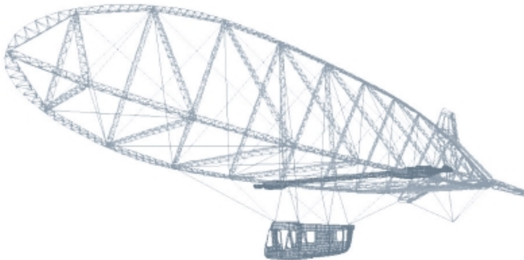
TRAGSTRUKTUR EINES HALBSTARREN LUFTSCHIFFS (ZEPPELIN LZ N07)
