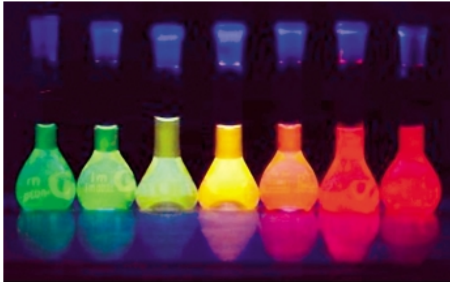
Abb. 3: Lösungen verschieden großer CdTe-Halbleiter-Nanopartikel. Übergang von grüner zu roter Fluoreszenz mit zunehmender Partikelgröße von ca. 2 auf 5 nm
