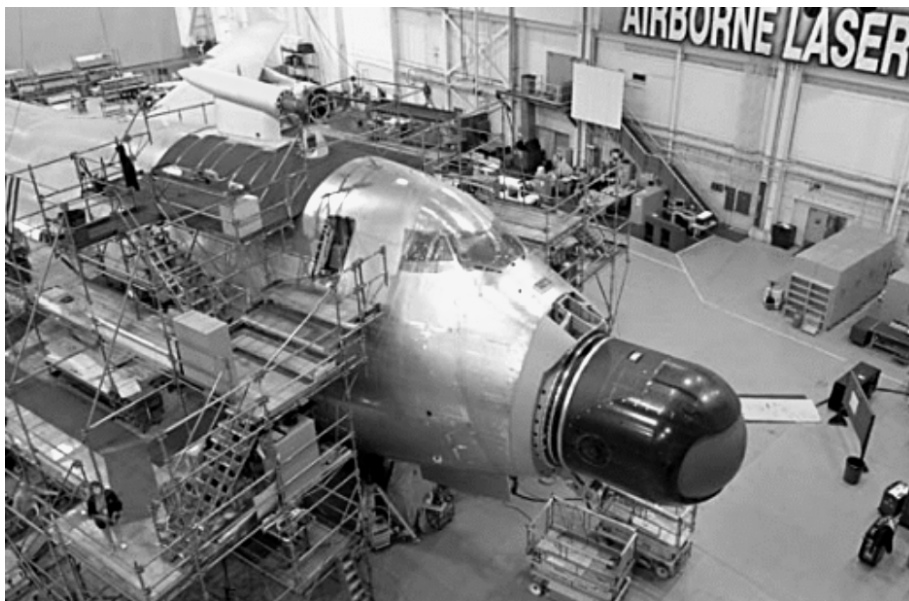
Abb. 11: Montage des Airborne Laser in einer Boeing 747-400F
