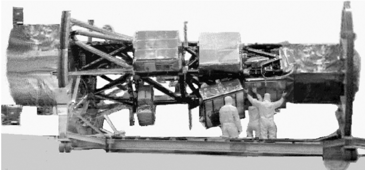
Abb. 6: Montage eines Lacrosse-Radaraufklärungssatelliten
