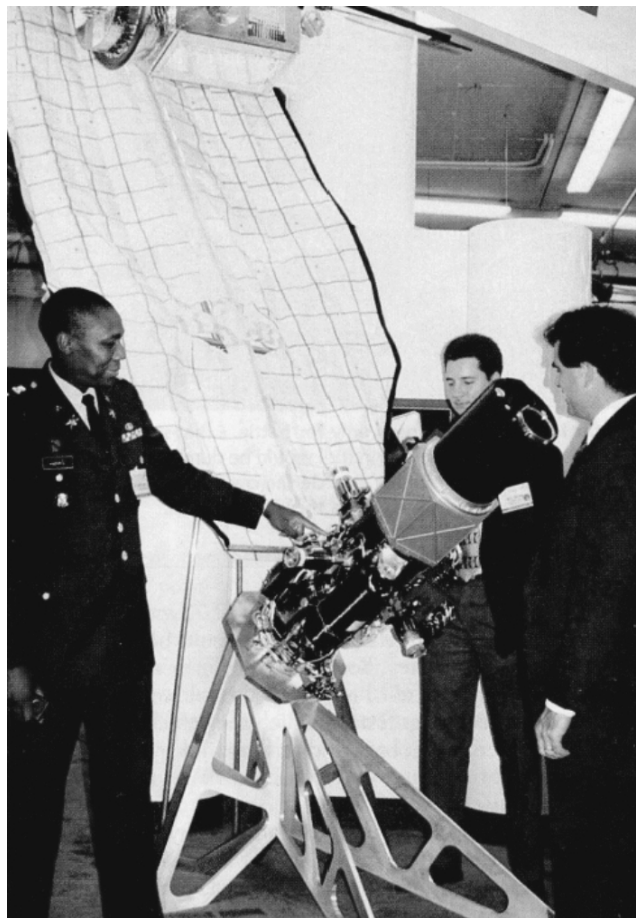
Abb. 8: KE-ASAT-Kill-Vehicle von Boeing/US Army mit Segel zur Beschädigung des am oberen Bildrand dargestellten Ziels
