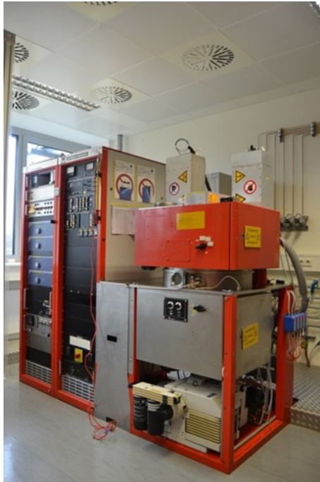
Abbildung 3.3: PVD-Beschichtungsanlage der Firma Leybold Heraeus des Typs Z 550.
