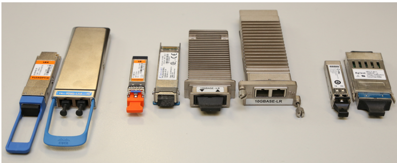
Abb. 2: Evolution der Transceiver 1G, 10G, 100G
