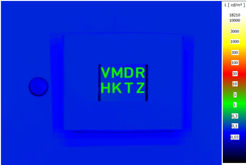
Abbildung B.3: Leuchtdichtebild in logarithmischer Darstellung in 7 Dekaden eines Ausschnittes mit nicht ausgeschalteter Blendquelle und Buchstabenmatrix bei aktiver Umfeldbeleuchtung. Die Schatten um die Ausschnittblenden für die Matrix resultiert aus dem Aufbau. Der Monitor wurde auf die Wand moniert, darauf dann der ND-Filter und darauf die Ausschnittblende für den 2°-Beobachter. [100]
