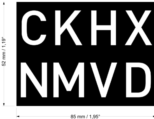
Abbildung 6.3: Bemaßung der Buchstabenmatrix [100]
