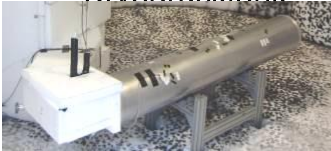
Vorschädigung durch eine Nut unter der Außenhülle
