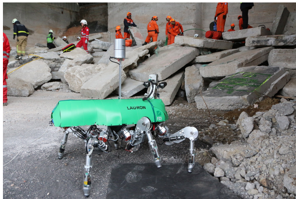
Bild A.22.: LAURON V wurde bei der Katastrophenschutzübung TARANIS mit zahlreichen Sensoren ausgestattet um bei der Suche nach verletzten Personen zu unterstützen.
