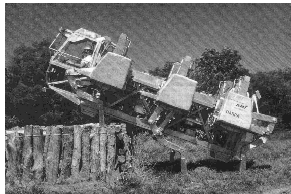
Bild A.6.: (links) Six-Legged Walking Machine von Sutherland aus dem Jahr 1983. Quelle [209], (rechts) Adaptive Suspension Vehicle : großer, hydraulischer Laufroboter mit guter Geländegängigkeit. Quelle [173]
