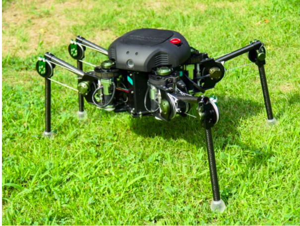
Bild A.15.: (links) TITAN XIII - Dynamisch laufender, vierbeiniger Roboter aus der TITAN Laufroboter-Familie. Quelle [126]; (rechts) Sehr schneller, leichter und kleiner Laufroboter DASH . Quelle [31]
