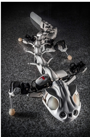
Bild A.17.: (links) Biologisch motivierte Laufroboter Pleurobot . Quelle [118]; (rechts) MIT Cheetah 2 Laufroboter nach dem Vorbild eines Gepards. Quelle [71]
