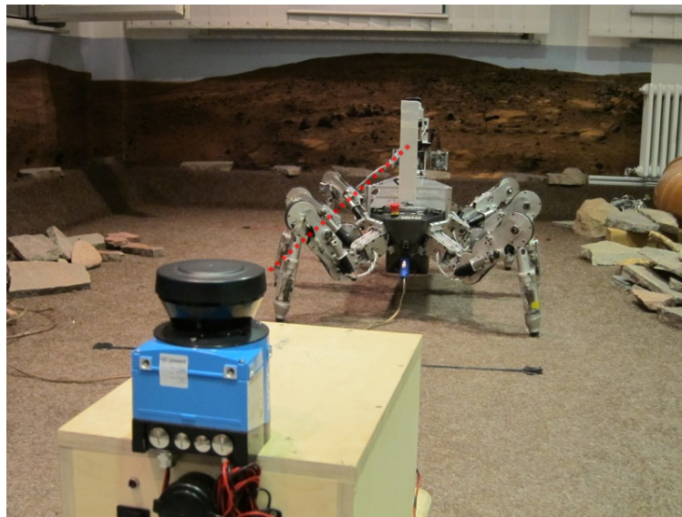
Bild 7.1.: Evaluation der Laufgeschwindigkeit mittels 2D-Linienscannern. Quelle [Hep11]
