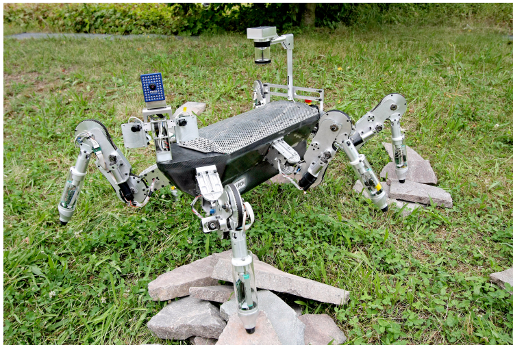
Bild 3.14.: Vierte Generation des sechsbeinigen Laufroboters LAURON : LAURON IVc besitzt eine biologisch inspirierte Kinematik mit einer robusten Mechanik, die den Einsatz des Roboters auch in schwierigen Gelände möglich macht.
