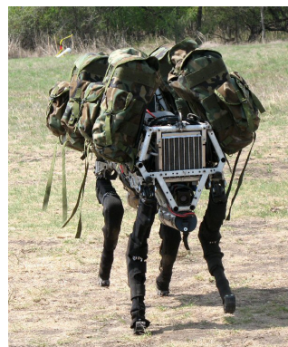
Bild A.12.: (links) Sechsbeiniger Laufroboter Katharina kann dank der kraftbasierten Regelung als mobile Werkzeugplattform eingesetzt werden. Quelle [190]; (rechts) Der Laufroboter BigDog war der erste mehrbeinige Laufroboter von Boston Dynamics und beeindruckte bereits zu Beginn mit seiner stabilen, robusten Lokomotion. Quelle [36]
