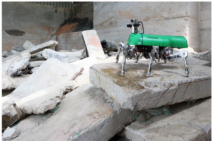
Bild 1.3.: Zur Evaluation eingesetzter sechsbeiniger Laufroboter LAURON : (links) LAURON IVc , (rechts) LAURON V
