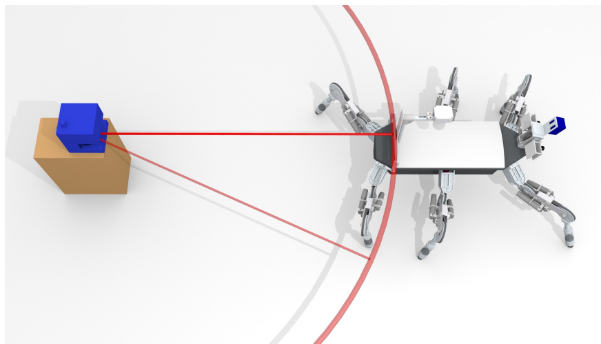
Bild 5.5.: Einsatz eines 2D-Linienscanners zur Erfassung der Position des Laufroboters. Aus der präzisen Positionsmessung kann anschließend die Laufgeschwindigkeit ermittelt werden. Quelle [Hep11]
