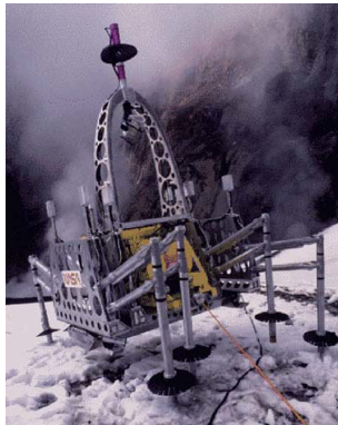
Bild A.7.: (links): Der achtbeinige Laufroboter DANTE II lief im Jahr 1994 erfolgreich in einen Vulkankrater hinab, Quelle [157], (rechts) Der sechsbeinige Genghis wurde vor allem eingesetzt um verhaltensbasierte Software zu evaluieren, Quelle [119]
