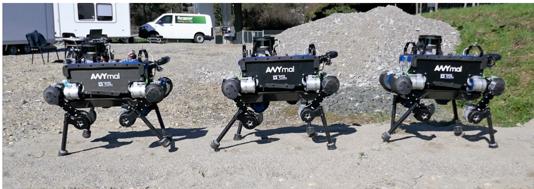
Bild 3.11.: Der Laufroboter ANYmal kann durch die integrierte Kraftregelung auch im Sand robust und effizient laufen. Quelle [131]
