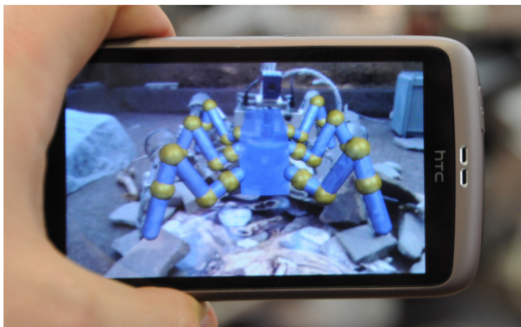
Bild 7.12.: Die Augmented Reality Darstellung auf dem Smartphone erlaubt es den virtuellen, simulierten Roboter direkt mit dem realen System zu vergleichen. Quelle [Sut12]
