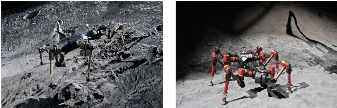
Bild A.9.: (links) Der sechsbeinige Laufroboter SpaceClimber wurde speziell für planetare Explorationsmissionen entwickelt. Quelle [18]; (rechts) CREX ist die Weiterentwicklung des SpaceClimber , der in einem Roboterteam für Weltraummissionen eingesetzt werden soll. Quelle [180]
