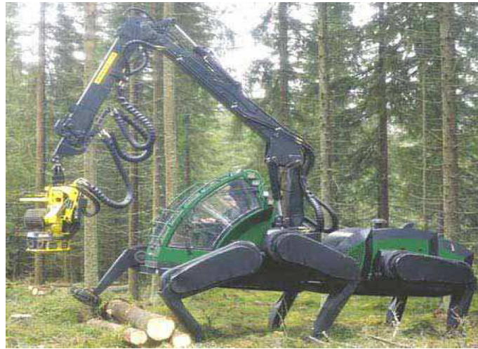
Bild A.23.: Der Plustech Harvester wurde entwickelt um Wald- und Forstarbeiten in schwierigem Gelände durchzuführen und gleichzeitig den Waldboden zu schonen. Quelle [44]
