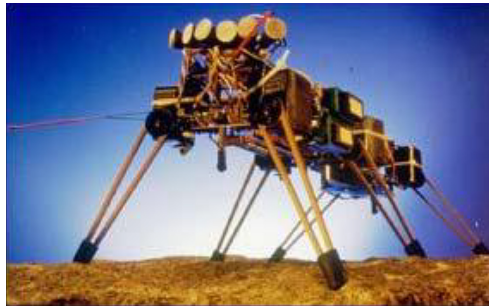
Bild A.7.: (links): Der achtbeinige Laufroboter DANTE II lief im Jahr 1994 erfolgreich in einen Vulkankrater hinab, Quelle [157], (rechts) Der sechsbeinige Genghis wurde vor allem eingesetzt um verhaltensbasierte Software zu evaluieren, Quelle [119]
