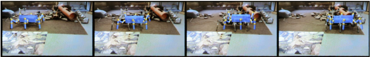
Bild 7.13.: Evaluation anhand eines virtuellen Wettrennens zwischen der dynamischen Simulation und dem realen Roboter. Quelle [Sut12]
