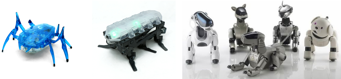
Bild A.27.: Entertainment Laufroboter: (links) Hexabugs der Firma Innovation First International, Inc.; (mittig) Kamigami eine Variante des DASH Roboters; (rechts) neueste Generation des berühmten SONY aibo , [122].
