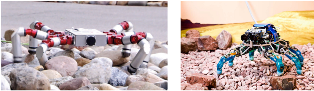
Bild A.14.: (links) Modularer, rekonfigurierbarer Laufroboter Snake Monster . Quelle [215]; (rechts) Der kleine DLR-Krabber wurde aus sechs Finger der DLR-Hand II aufgebaut. Quelle [86]
