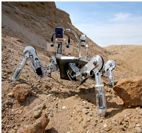
Bild 1.3.: Zur Evaluation eingesetzter sechsbeiniger Laufroboter LAURON : (links) LAURON IVc , (rechts) LAURON V
