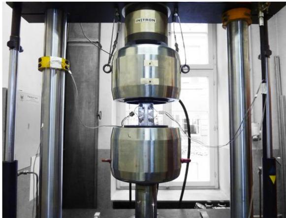
Abbildung 3.38: Versuchsaufbau zur Prüfung der MT-Proben, eingespannte MT-Probe mit Rissfortschrittsensoren (Typ FAC-20)
