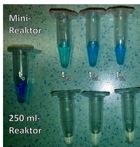
Abbildung 3.3.: Proben der Elektrofermentationen im Mini-Reaktor und 250 ml-Reaktor zu den Zeitpunkten 0 (Mini-Reaktor repräsentativ für beide), 24, 48 und 72 h.
