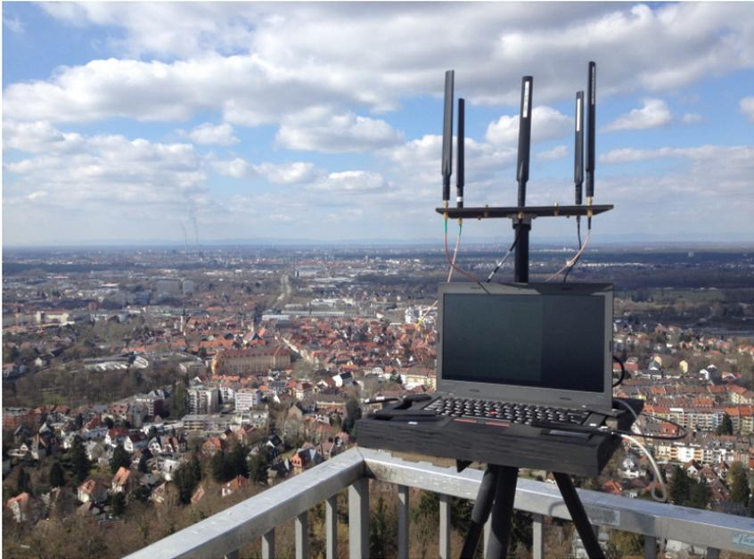
**Abbildung 5.2:** Messsystem auf dem Aussichtsturm am Stadtrand (Standort B1) bestehend aus Notebook und USRP B210 mit vorgeschaltetem LNA.
