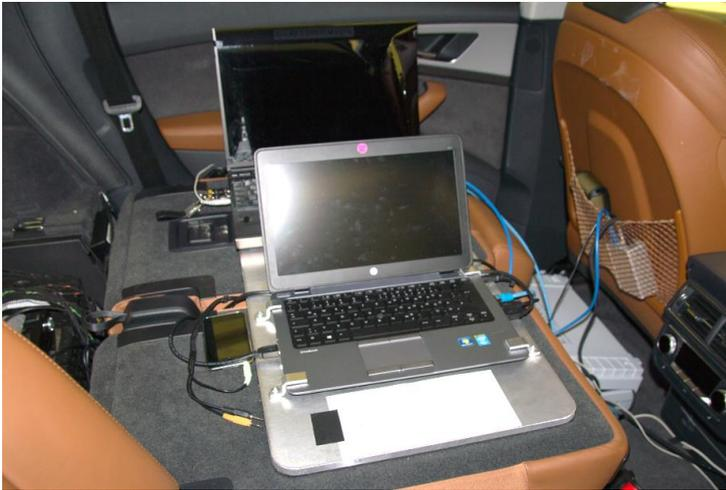
**Abbildung 4.39:** Positionierung der Laptops (vorderer Laptop für ADTF, hinterer Laptop für Eyetracking) auf der umgeklappten Rückbank des Versuchsfahrzeugs und Apple iPod für Nebenaufgabe
