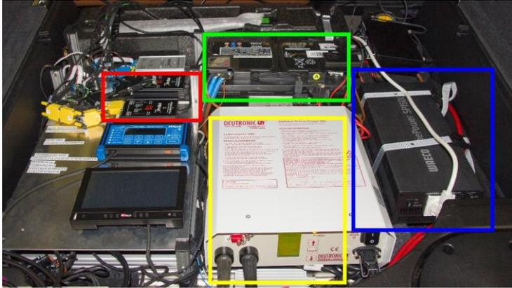
**Abbildung 4.40:** Technischer Aufbau im unteren Ladeboden des Kofferraums, roter Rahmen = CAN Gates, grüner Rahmen = Zweitbatterie, gelber Rahmen = Ladegerät, blauer Rahmen = Spannungswandler 12 V auf 230 V
