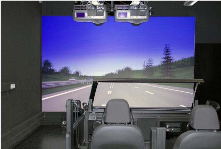
**Abbildung 4.6:** Aufbau Simulator für Studie A mit 3,8 m breiter Leinwand und 3,8 m Entfernung vom Auge des Fahrers zur Leinwand
