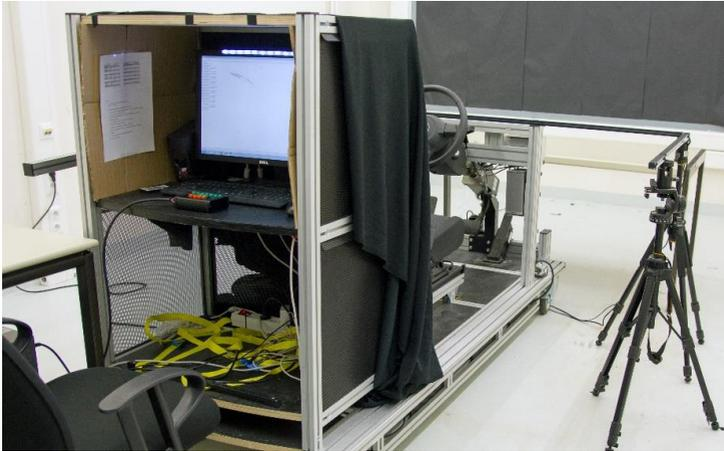
**Abbildung 4.15:** Versuchsleiterarbeitsplatz mit Kontrollcomputer für technischen Aufbau mit Verdunklung des Bildschirms in Richtung Proband und Position des externen Bedienteils mit Tastern
