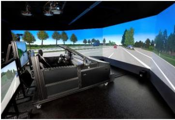
**Abbildung 4.21:** Aufbau Simulator für Studie C mit 3 Front- und 2 Seitensichten a 3 m Leinwandbreite, Abstand Auge des Fahrers zur Leinwand beträgt 3,5 m
