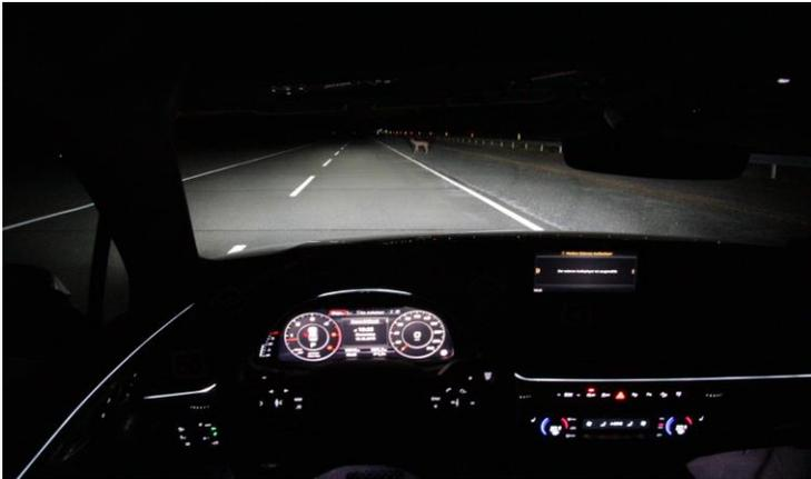
**Abbildung 4.38:** Durchgängige weiße Lichtlinie im Versuchsfahrzeug Audi Q7 und Verdeckung der Lichtlinie durch Lenkrad aus Kameraposition
