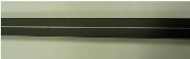
**Abbildung 4.3:** Abgeklebte LED Leiste mit einer sichtbaren Öffnung der ambienten Innenraumbeleuchtung von 1 mm Höhe
