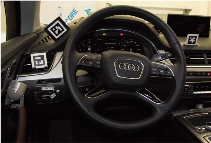
**Abbildung 4.41:** Positionierung der QR Codes für die Blickerkennung im Versuchsfahrzeug
