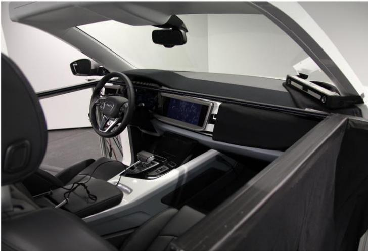
**Abbildung 4.20:** Sitzkiste und erweiterter Versuchsaufbau für Studie C, Anordnung der LED Leisten in schwarz und des Trackers für die Eye-Tracking Brille im Fahrzeugcockpit
