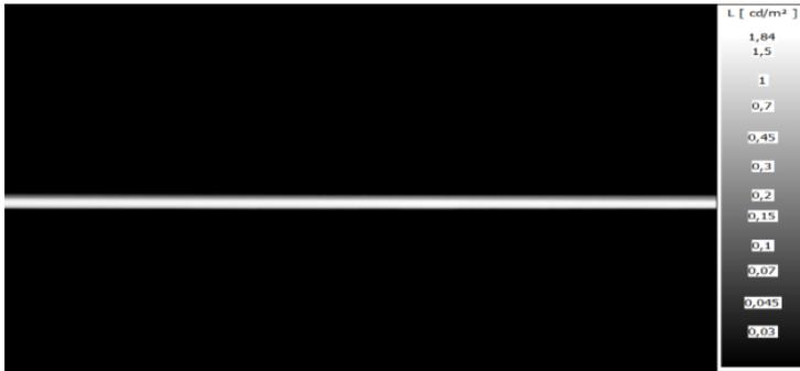
**Abbildung 4.4:** Leuchtdichtemessung eines Testaufbaus zur Homogenitätsbewertung, Farbe Rot, Ansteuerung der LED mit 2 von 255 Stufen der Primärvalenz Rot, 5V, f50, ohne Filter, Abstand LED Leiste zu Leuchtdichtekamera 1150 mm
