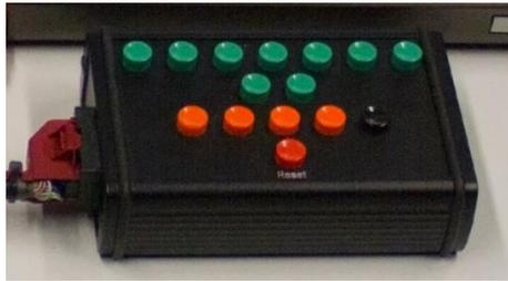
**Abbildung 4.5:** Externes Bedienpanel mit Tastern für die Ansteuerung des Mikrocontrollers
