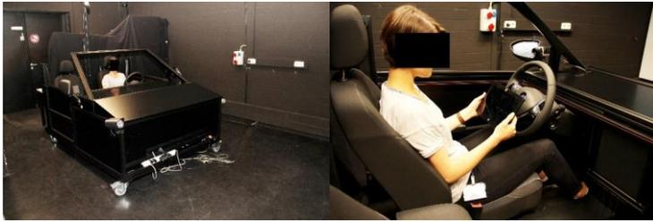
**Abbildung 4.7:** Links: Aufbau der Sitzkiste im Fahr Simulator, Rechts: Sitzposition des Probanden in der Sitzkiste mit Tabletposition und LED ambiante Innenraumbeleuchtung
