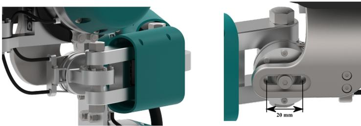
(a) Detaillierte Ansicht der Konstruktion am Gelenk  $\theta_5$ . (b) Schraubmechanismus zur Einstellung von  $\theta_5$  in mediolateraler Richtung.
