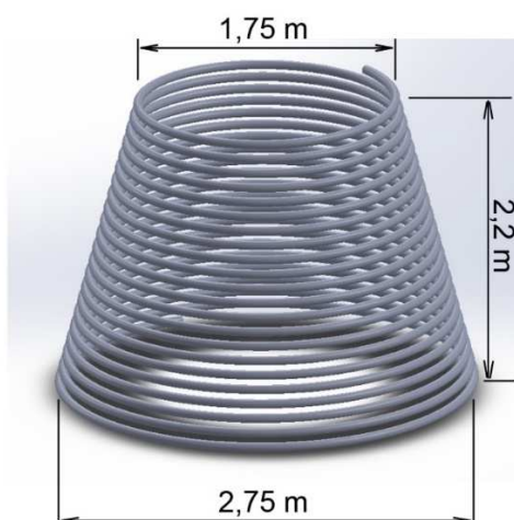
Abbildung 4-3 - geometrische Grunddaten des Lichtkollektorerüstes
