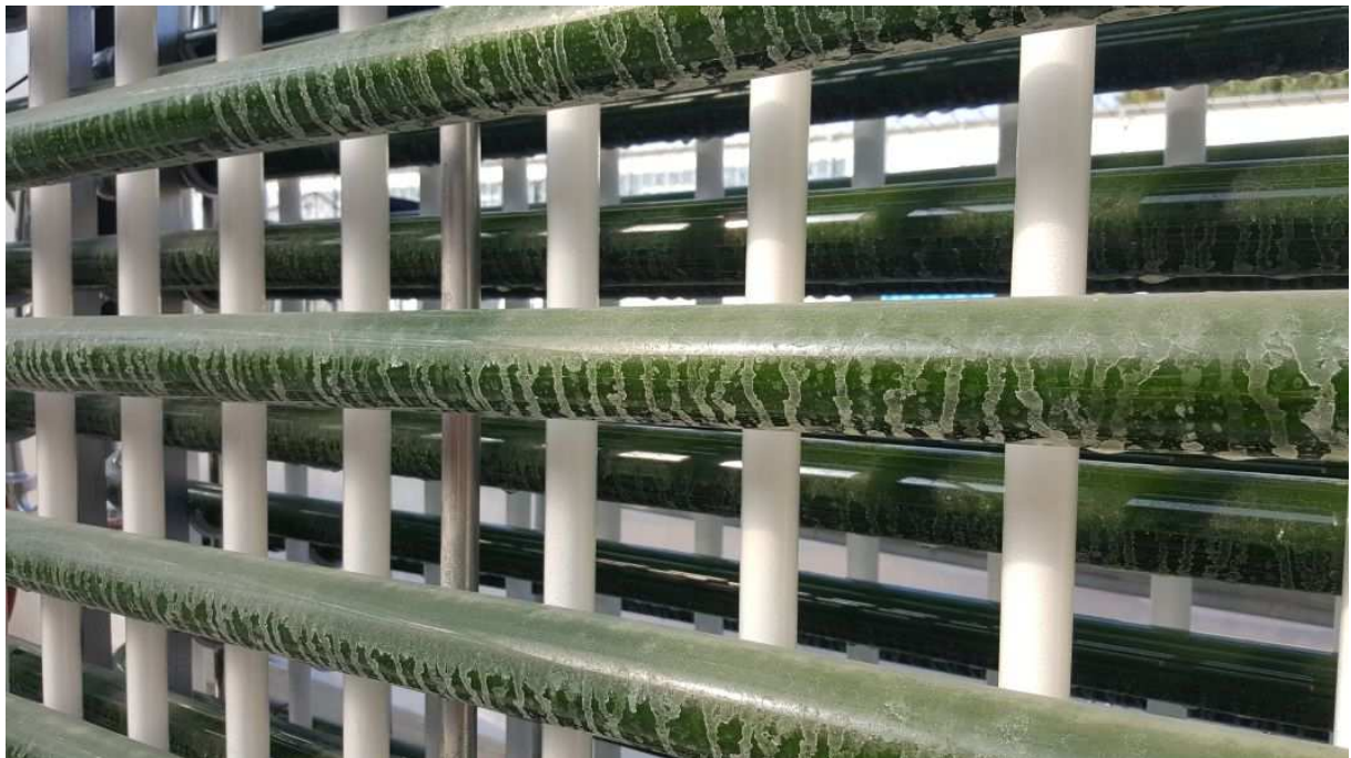
Abbildung 6-1 - mineralische Ablagerungen in Folge von Verdunstung nach Kühlung mit temperaturgesteuerter Verneblungsschläuchen; Testkultivierung mit TBR100, bestehend aus Glasröhren (Aufnahmedatum: 16.09.2016)
