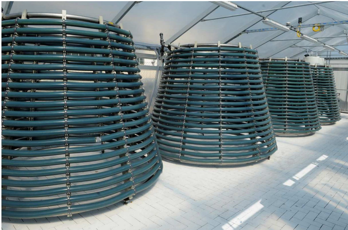
Abbildung 4-1 – Darstellung der 4 Lichtkollektoren (jeweils 2 Lichtkollektoren – sowohl vordere zwei und hintere 2 – konnten zu jeweils einer Teilanlage zusammengefasst werden)
