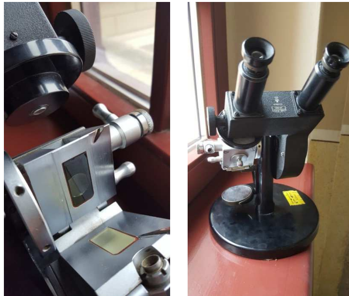
Abbildung 4-5 - Abbe-Refraktometer (HS Anhalt FB6, Prof. Zschebye)
