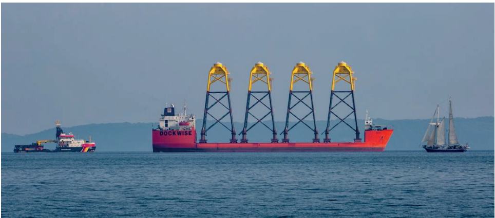
Abbildung 1.1: Transport von Jacket-Konstruktionen auf See (Foto: Gerd Wiese)
