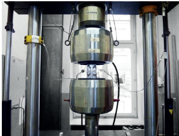
Abbildung 3.38: Versuchsaufbau zur Prüfung der MT-Proben, eingespannte MT-Probe mit Rissfortschrittsensoren (Typ FAC-20)
