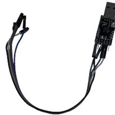
Abbildung 4.10: CP2102 zur Datenübertragung in Echtzeit per UART [Bus16]
