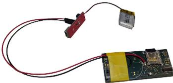
Abbildung 4.9: Platine mit Ein-/ Ausschalter, RGB-LED und Akku [Bus16]
