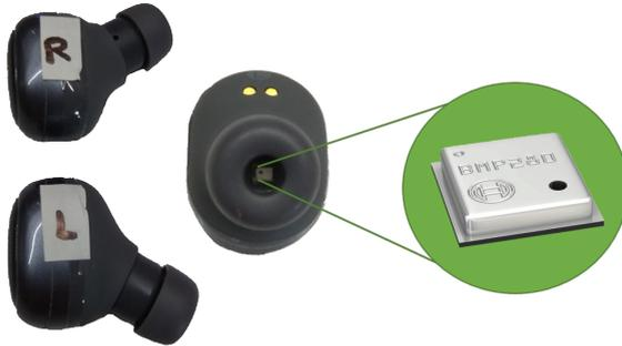
Abbildung 4.12: Ohrteil mit integriertem Drucksensor [Bus18] [BOS]
