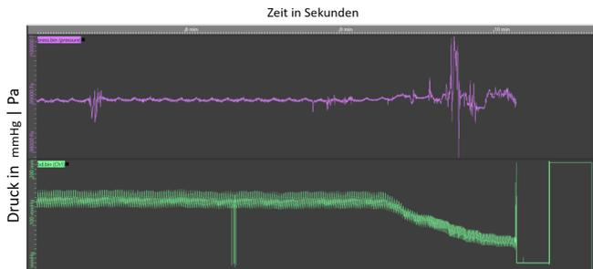
Abbildung 5.5: Übersicht der beiden aufgenommen Signale der Schweinemessungen, oben Ohrdruck, unten Referenzdruck (invasiv gemessen)
