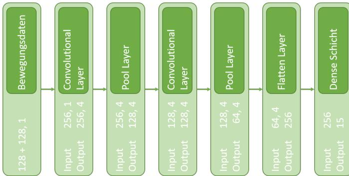
Abbildung 6.22: Layer-Übersicht des implementierten CNN
