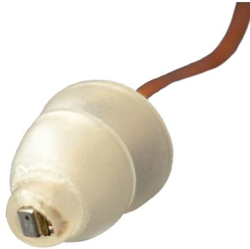
Abbildung 4.3: In den Verschluss integrierter Drucksensor [SZPS16]
