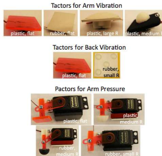
Abb. 4. Beispiele für haptische Aktuatoren[6]. Es liegt eine Unterscheidung von dem Verwendungszweck, dem verwendeten Material und der Form des Materials vor.
