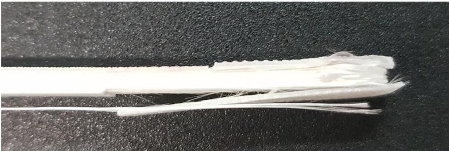
Abbildung 6-24: Versagensverhalten der Probekörper mit vollflächiger Füllung
