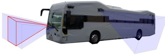
Abbildung 9.4: Sichtbereiche des verwendeten MKS im Future Bus.
