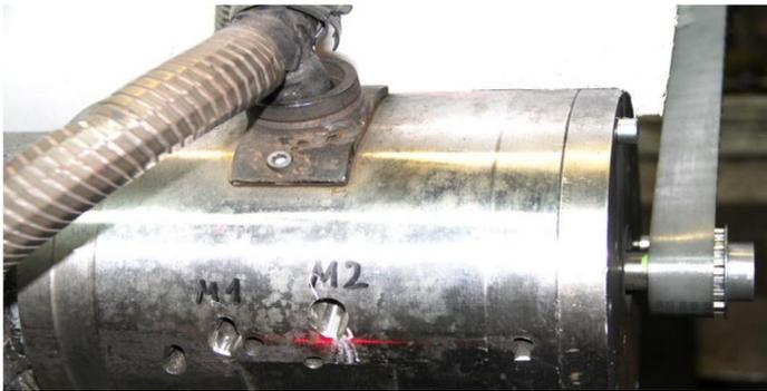
Abbildung 8.1: Berstschutz für Schleuderversuche mit Antriebsriemen und Durchgängen für die Laser-Wegmessung
