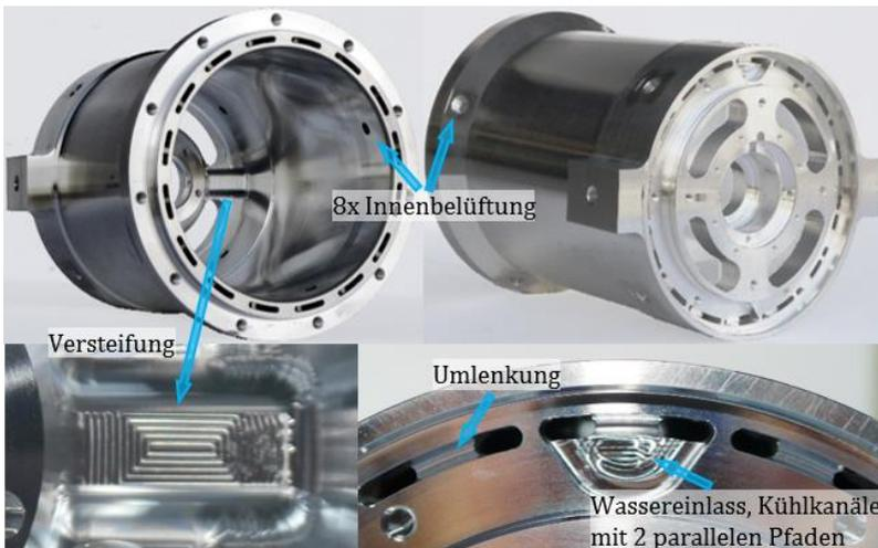
Abbildung 7.27: Statorgehäuse mit Öffnungen für die Wicklungsenden im Topfboden, Kühlkanälen und Versteifungen
