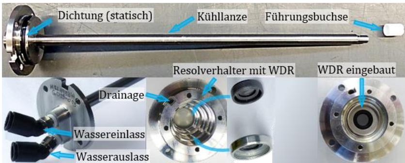
Abbildung 7.26: Kühllanze und Dichtelemente der Wellenkühlung
