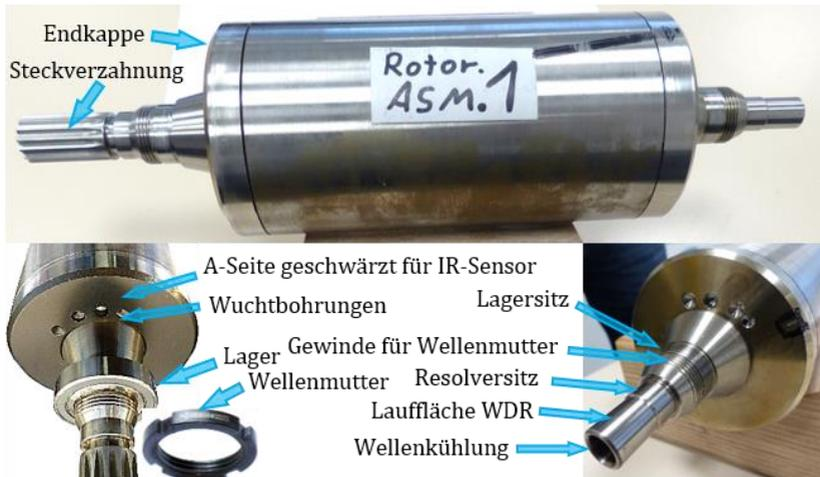
Abbildung 7.25: Fertiger Rotor mit Steckverzahnung A-seitig und Bohrung für die Wellenkühlung B-Seitig
