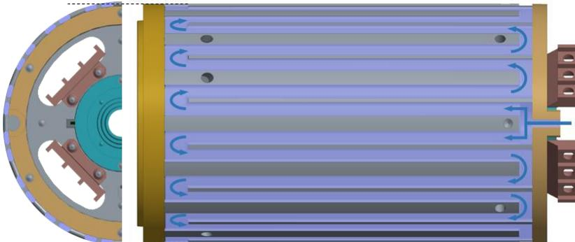
Abbildung 7.6: Konstruktion der Mantelkühlung, aufgeschnitten.
