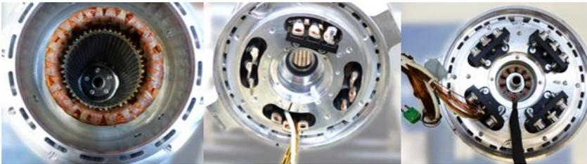
Abbildung 7.28: Statorpaket mit Wicklung im Gehäuse. Eingebautes Festlager im Topfboden. Mitte und rechts: Wicklungsenden mit Positionierung auf Klemmsteinen und eingebauter Resolver.
