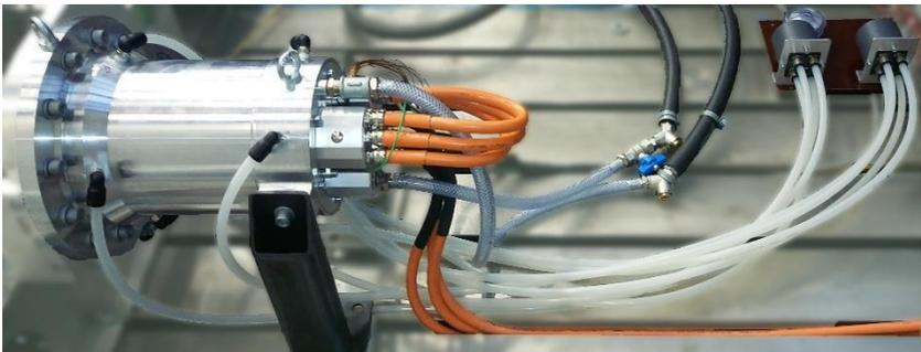
Abbildung 7.29: Fertig montierter Prototyp am Prüfstand mit Kühlmittelanschlüssen und Innenbelüftung.
