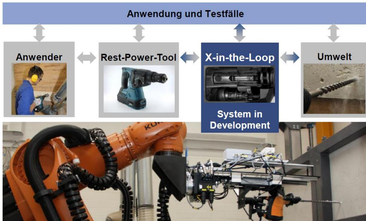
Bild 2-43: Der IPEK-X-in-the-Loop-(IPEK-XiL)-Ansatz für Power-Tools<sup>145</sup>
