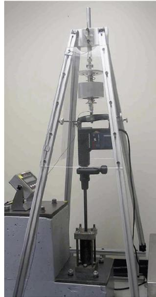
Bild 2-38: Prüfstand für einen Abbruchhammer<sup>132</sup> unter Verwendung eines Hand-Arm Modells mit zwei Freiheitsgraden<sup>133</sup>
