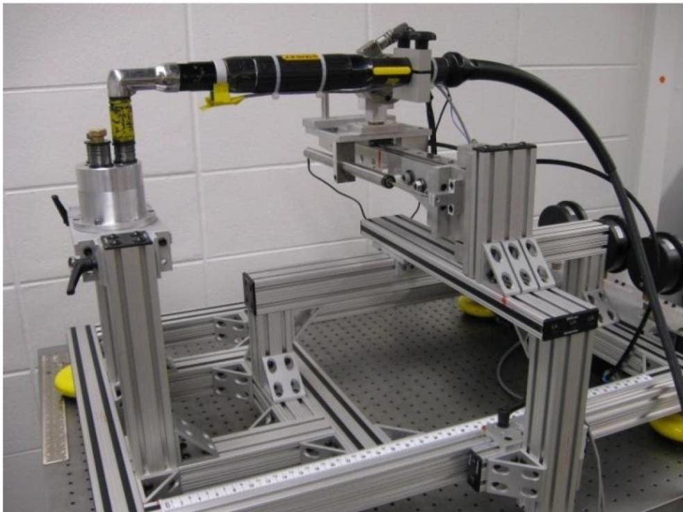
Bild 2-40: Prüfstand für Winkel-Schrauber mit Abbildung der passiven Anwendeigenschaften<sup>139</sup>
