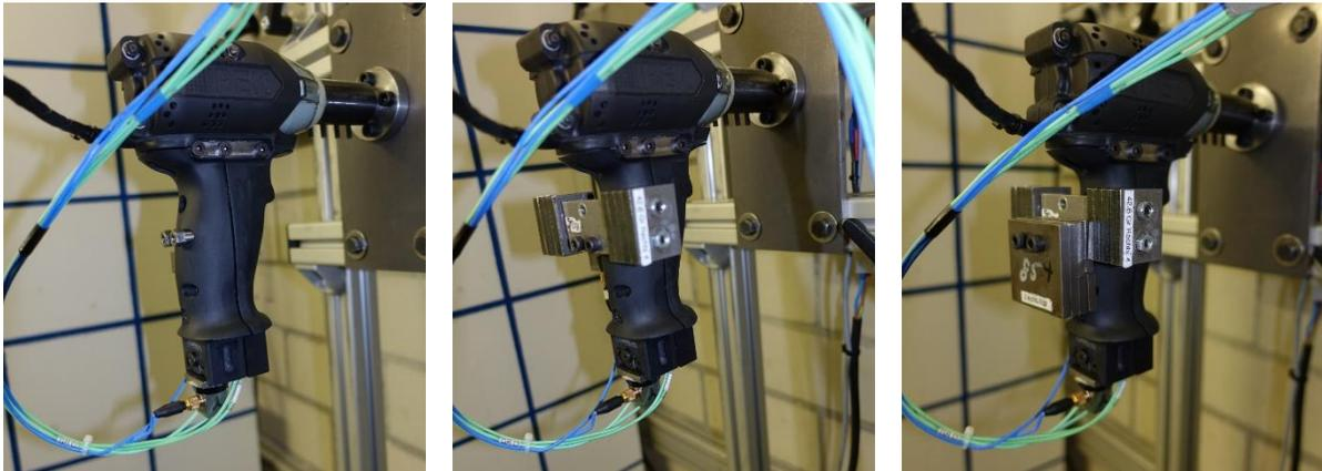
Bild 6-11: Verifikation des Messgriffes durch aufgebrachte Prüf-Massenträgheitsmomente.
