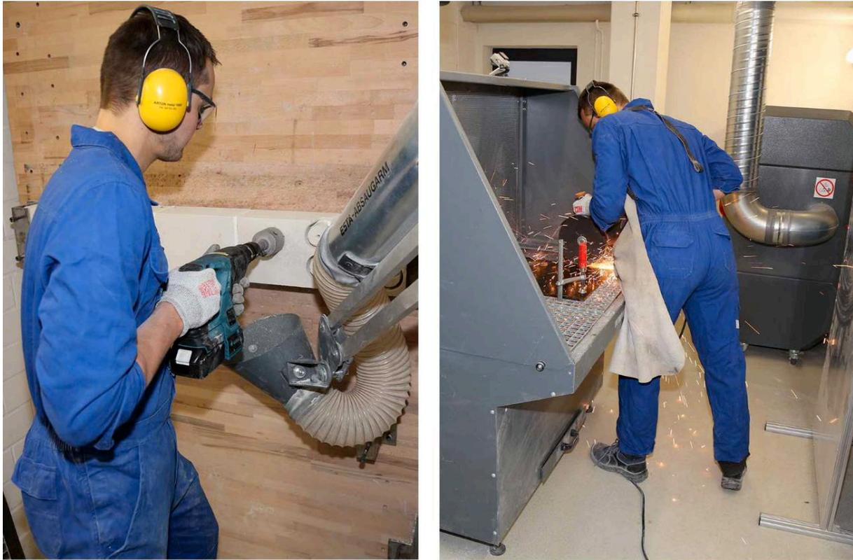
Bild 1-2: Typische Testumgebung zur Prüfung von Power-Tools mit Staubabsaugung<sup>20</sup>
