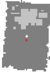
Abbildung 4.20: Das rote Kreuz stellt den Flächenschwerpunkt des Objektes dar, wenn dieses nicht aufgefüllt ist, d.h. wenn die hellgrau hinterlegten Bereiche nicht in die Schwerpunktberechnung eingeflossen sind. Werden die hellgrauen Bereiche berücksichtigt, verschiebt sich der Flächenschwerpunkt, dargestellt durch das weiße Kreuz.
