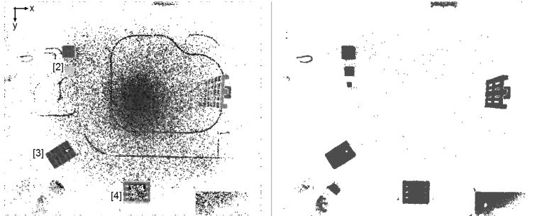
Abbildung 4.18: Gegenüberstellung der ursprünglichen Kameradaten eines Bildes links und der über mehrere Bilder hinweg gemittelten Daten rechts.
