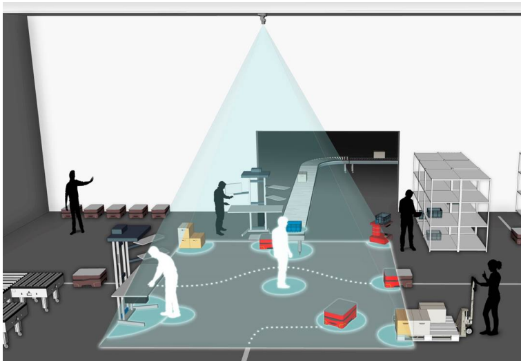
Abbildung 0.1: Schematische Darstellung des Lokalisierungssystems inklusive des überwachten Bereichs, in dem die fahrerlosen Transportfahrzeuge frei navigieren können.
