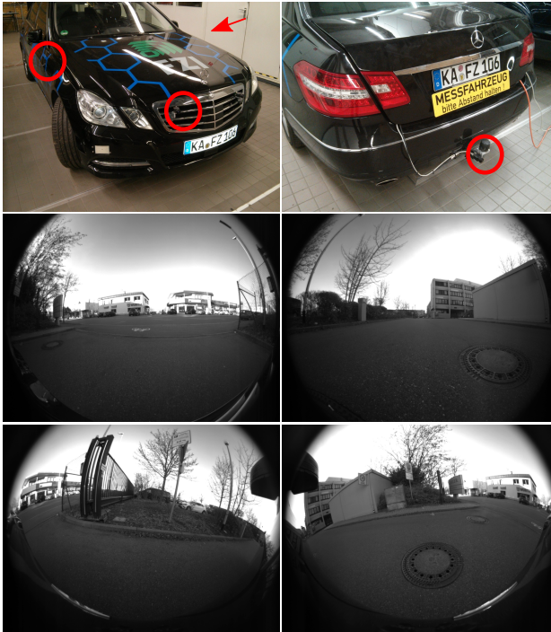
Abbildung 9.1: Das verwendete seriennahe MKS, welches im Rahmen des A2B-Projekts für die Lokalisierung verwendet wurde.
