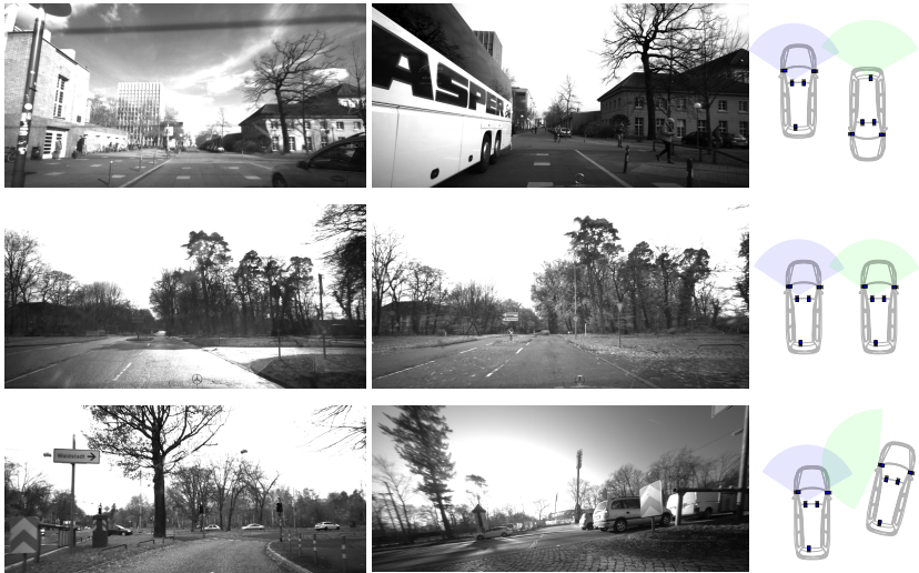
Abbildung 4.5: Exemplarische Auswahl von Bildpaarkombinationen, zwischen denen erfolgreich Merkmale mit der epipolargeometrischen Suchraumeinschränkung bestimmt wurden. Die Bilder entspringen dabei jeweils aus unterschiedlichen Aufnahmesequenzen.
