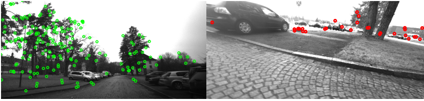
Abbildung 7.16: Projektionen von assoziierten Landmarken in das Bild einer vorwärts gerichteten Kamera (Links) und einer Seitenkamera (Rechts).
