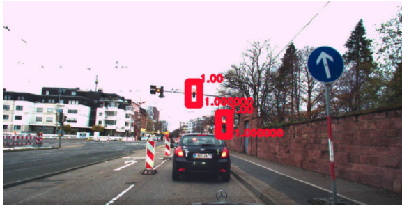
Abbildung 9.5: Klassifikation des Ampelstatus durch ein CNN anhand der Projektion einer kartierten Ampel in die aktuellen Kamerabilder auf Basis der Lokalisierung.
