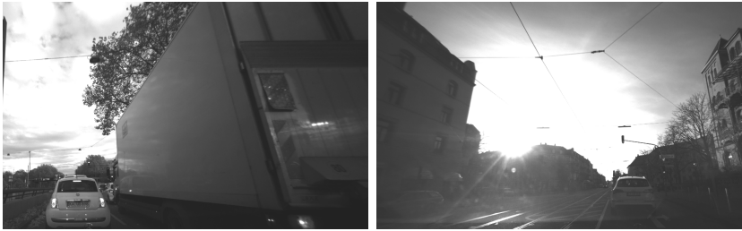
Abbildung 1.1: Verschiedene Problemszenarien. Links: Großflächige Verdeckung durch dynamische Objekte. Rechts: Schlechte Sichtbedingungen durch starke Sonneneinstrahlung.
