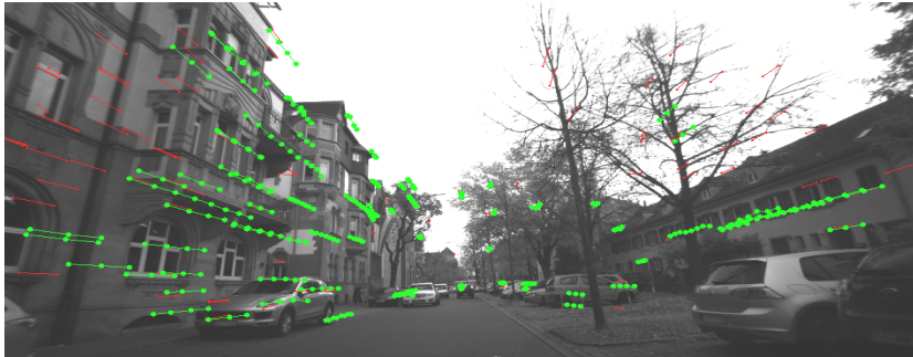
Abbildung 4.1: Darstellung des optischen Flusses einer in Fahrtrichtung ausgerichteten Kamera in einem typischen Stadtszenario.
