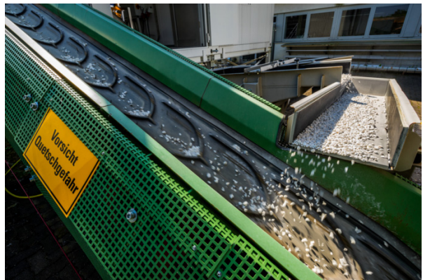
(d) Ascending conveyor.
