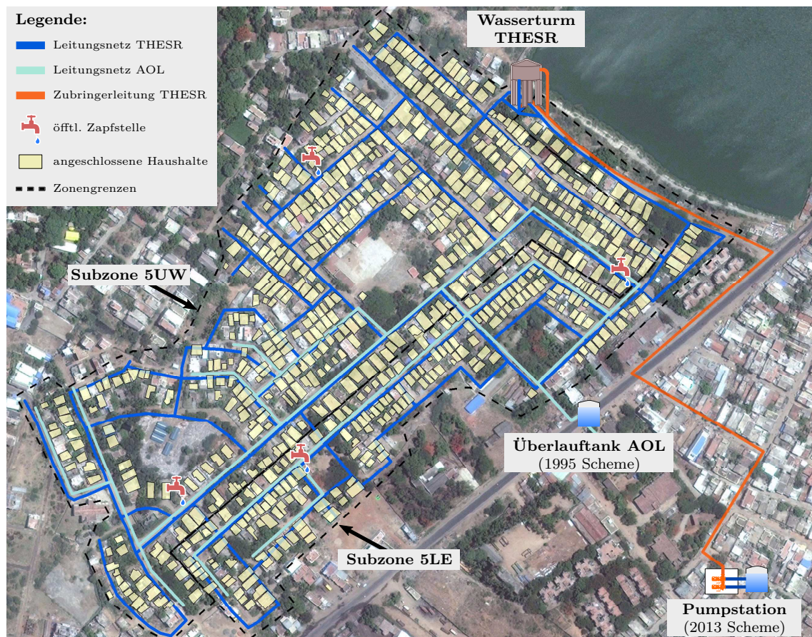
Abbildung 6.1: Wasserverteilungssystem des Pilotgebiets
