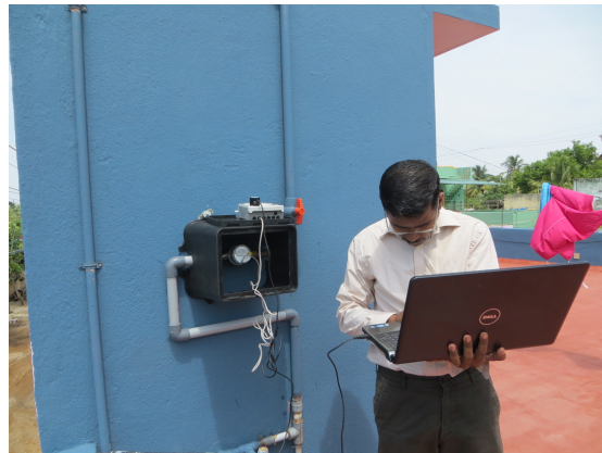
Abbildung 6.16: Auslesung eines Kundenwasserzählers mit Datenlogger
