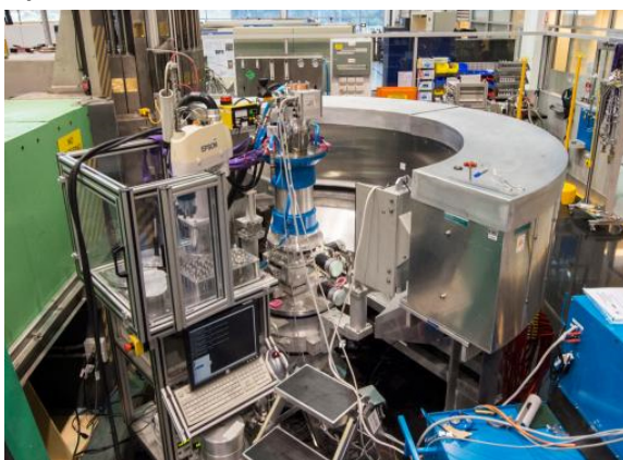
Abb. 3.8: a) Bild des hochauflösenden Pulverdiffraktometers (ECHIDNA) am ACNS [97] . b) Skizze des Probengefäßes mit dem unteren Teil des Probenhalters: 1) Mikrofilterdichtung 2) Probengefäßdichtung 3) Schrauben für die Probengefäßfixierung 4) Probengefäß 5) Probengefäßbefestigungsflansch [98] .
