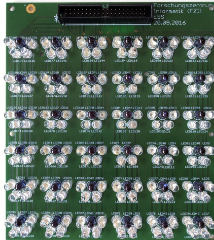
Bild 4.1: Bestücktes LED-Beleuchtungsmodul mit 5 Wellenlängen in 6x6-Matrix-Anordnung
