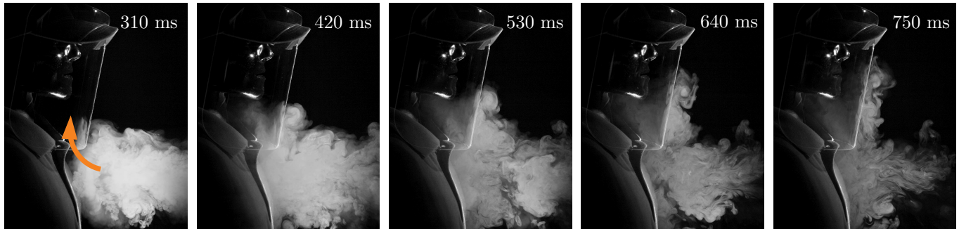
(b) Frontale, aufwärtsgerichtete Beaufschlagung der PlexyCap (Exp.2a); die Aerosolwolke tritt kinnseitig unmittelbar hinter das Visier (siehe Pfeil).
