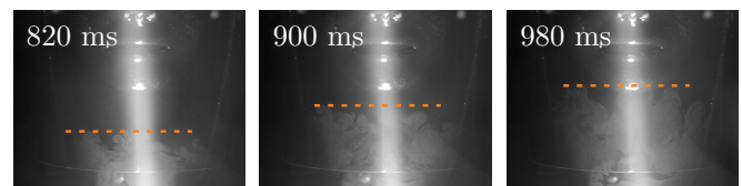
(b) Unterspülung des Kinnbereichs; die jeweilige Höhe der langsam aufsteigenden Aerosolwolke ist markiert
