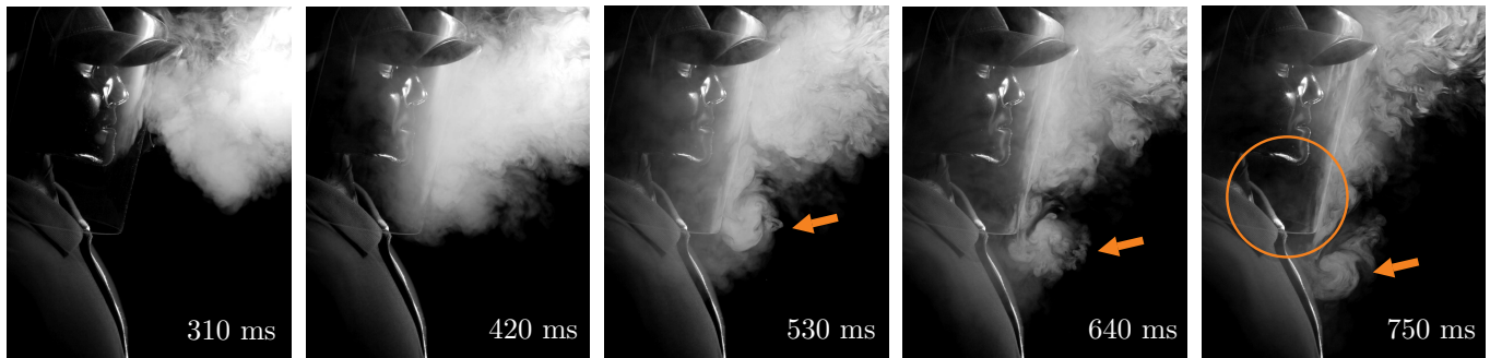
(a) Frontale, horizontale Beaufschlagung der PlexyCap (Exp.1a); eine wirbelartige Struktur entsteht und wandert nach unten (siehe Pfeile); die nachgelagerte Hinterspülung der Maske im gekennzeichneten Bereich wird in Abbildung 7(b) gezeigt.
