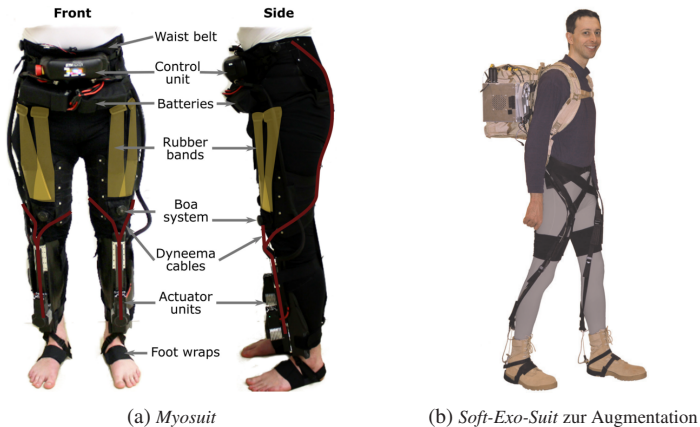
Abbildung 2.12: Beispiele für Soft-Exo-Suits : (a) Myosuit zur Kompensation von Muskelschwäche (Schmidt u. a. 2017, © 2017 IEEE), (b) Soft-Exo-Suit zur Augmentation von gesunden Benutzern (Asbeck u. a. 2015 © 2015 IEEE).
