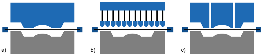
Abbildung 2-7: Vergleich eines a) globalen Werkzeugs, b) MPF-Werkzeugs und c) segmentierten Werkzeugs
