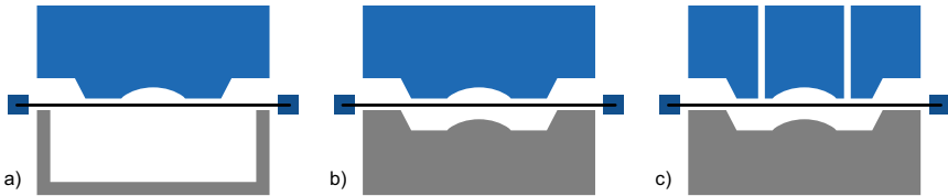
Abbildung 2-6: a) Einseitiges, b) zweiseitiges und c) segmentiertes Werkzeug nach (Bhattacharyya 1997, S. 65–71; Fleischer & Lanza et al. 2012, S. 132)
