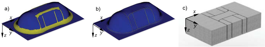
Abbildung 7-5: a) Binarisierte Kritikalitätsmatrix, b) skelettierte Kritikalitätsmatrix und c) Ergebnis der Segmentierung des Werkzeugsystems für die DD-Geometrie
