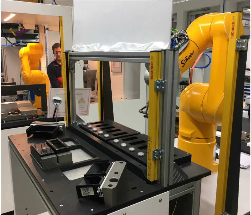
Abbildung 5.12: Bereich der Kollaboration im Anwendungsfall Euchner, in dem die MGB2 Submodule zwischen Anlage und Werker ausgetauscht werden. Das Foto entstand während der Inbetriebnahme der Anlage.
