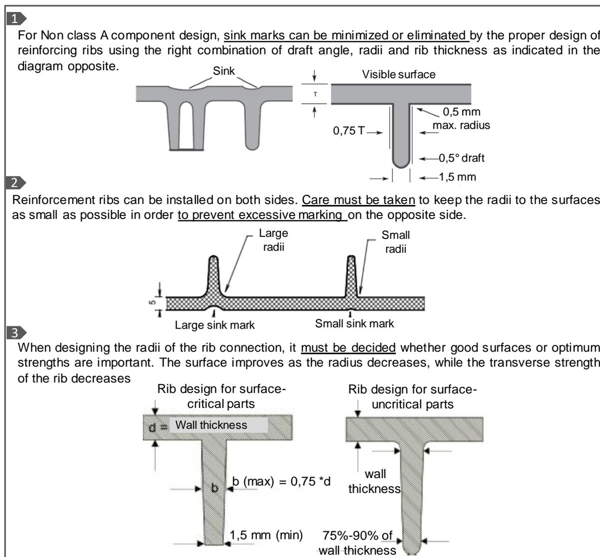
Figure 78: Design recommendations for rib design for SMC material (1) (European Alliance for SMC/BMC, 2007), (2) (Wernli, 1998)<sup>135</sup>, (3) (AVK – Industrievereinigung Verstärkte Kunststoffe e. V., 2013, p. 420)<sup>136</sup>
