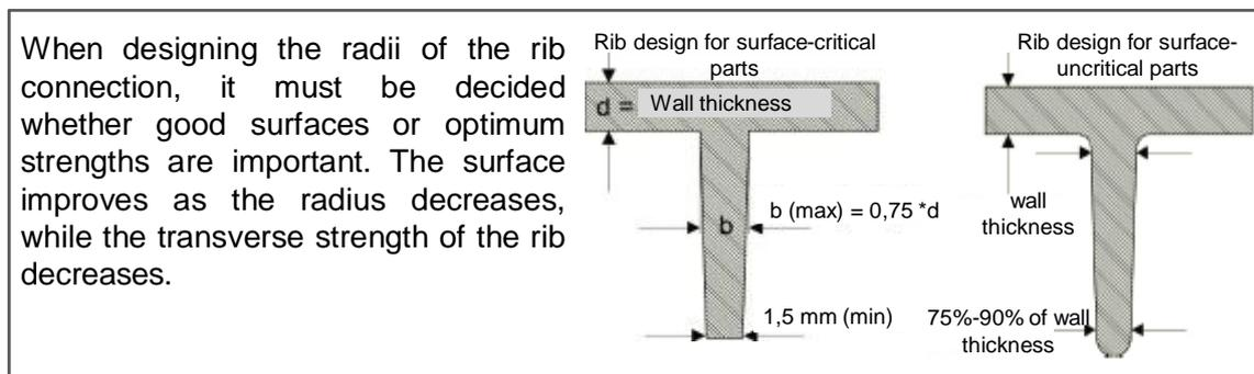
Figure 21: An example of a design guideline for SMC adapted from AVK (AVK – Industrievereinigung Verstärkte Kunststoffe e. V., 2013, p. 420)<sup>17</sup>
