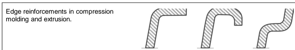
Figure 22: An example of a design guideline for LFT adapted from AVK (AVK – Industrievereinigung Verstärkte Kunststoffe e. V., 2013, p. 435)<sup>18</sup>
