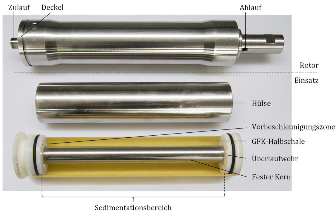
**Abbildung 8.1:** Rotor mit entwickeltem Einsatz im zerlegten Zustand
