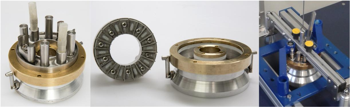
**Abbildung 7.4:** Modifizierte Scherzelle in geschlossenem a) und geöffnetem b) Zustand. In c) ist die Scherzelle in Betrieb zusammen mit dem Querbalken und den Halterungen für den Außenring des Scherzellendeckels zu sehen.
