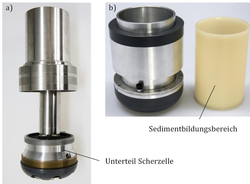
**Abbildung 7.5:** Zentrifugeneinsatz a), um die zu untersuchenden Sedimente direkt im Unterteil der Scherzelle zu bilden und zu konsolidieren. In b) ist der Ausgleichsbecher zur Kompensation der Verschiebung des Schwerpunkts durch die Sedimentbildung gezeigt.
