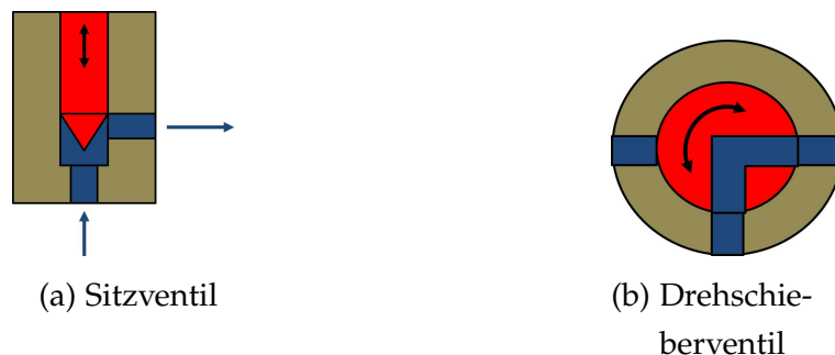
Abb. 3.1: Schematische Darstellung eines Sitz- (a) und eines Drehschieberventils (b). Das Gehäuse ist jeweils grau, das bewegliche Element rot und der Raum für das geschaltete Fluid blau eingefärbt.
