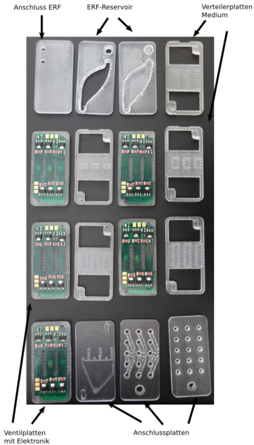
Abb. 6.22: Übersicht über die 16 Platten des Ventilstapels. Diese werden von links oben zeilenweise nach rechts unten aufeinander geschweißt.
