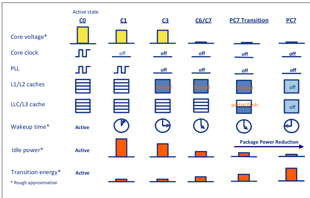
Abbildung 2.4: Eine Übersicht der unterschiedlichen C-States mit dem dazugehörigen Status des CPU-Kerns [46].
