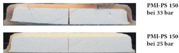
Abbildung 5.29: Analyse des Probeninneren von PMI-PS 150, Ergebnisse aus dem RTM-Prozess nach einem Maximaldruck von 33 bar (oben) und 25 bar (unten) bei 80°C Werkzeugtemperatur
