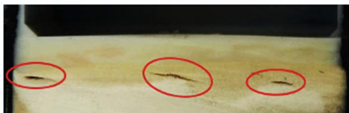
Abbildung 4.11: Kernrisse durch Harzeindringen und Schwindung
