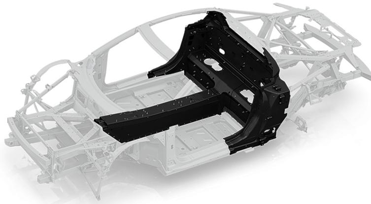
Abbildung 1.1: Einsatz von CFK im Rohbau des Audi R8 Spyder (Deinzer 2016)
