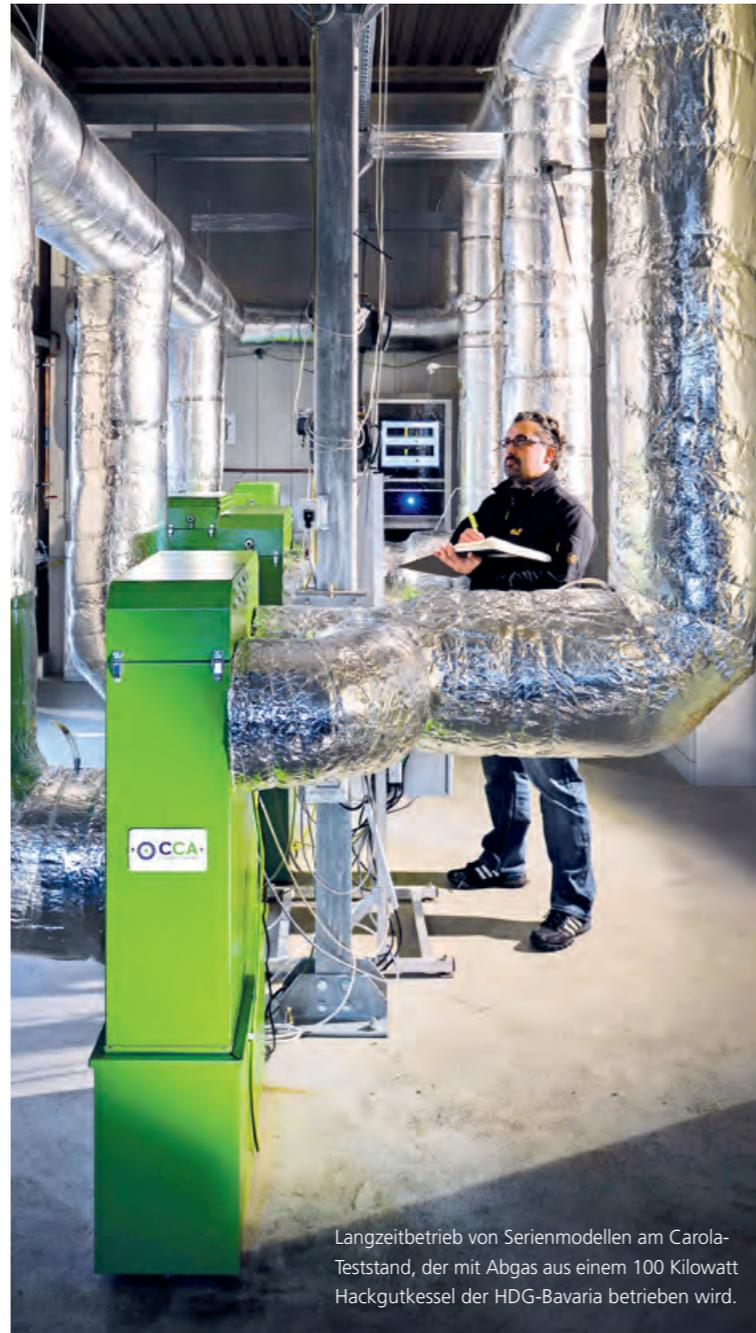
Langzeitbetrieb von Serienmodellen am Carola-Teststand, der mit Abgas aus einem 100 Kilowatt Hackgutkessel der HDG-Bavaria betrieben wird.
