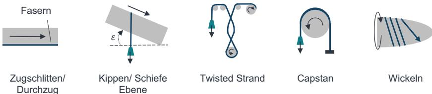
Abbildung 4-12: Übersicht der Methoden zur Untersuchung des Reibverhaltens für das Faserwickeln (in Anlehnung an (Koussios & Bergsma 2006)).
