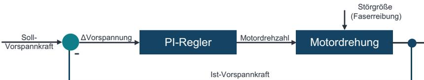
Abbildung 6-9: Blockschaltbild der Vorspannungsregelung
