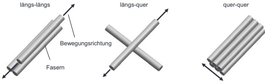
Abbildung 4-11: Möglichkeiten der Faser-Faser-Reibung (in Anlehnung an (Gassara & Barbier et al. 2018))
