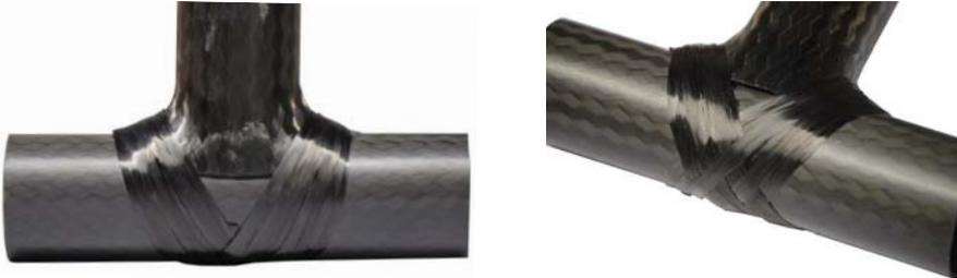
Abbildung 7-4: Rechtwinklige Fügeverbindung mit V-Wickelmuster und fünf Umwicklungen ( $n_{wick} = 4$ ) sowie einer Lagenteilung von  $Tl_{lagen} = (3,2)$
