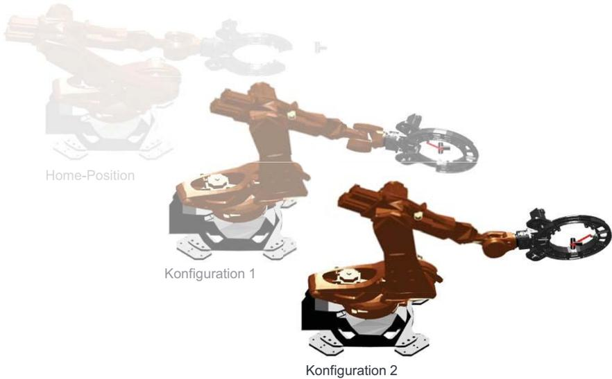
Abbildung 5-38: Schematische Darstellung zweier Gelenkwinkelkonfigurationen während des Wickelvorgangs (in Anlehnung an (A\_Gündisch 2018))
