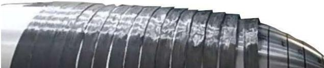
Abbildung 4-18: Treppenförmiges Aufstellen der Wicklungen (in Anlehnung an (A\_Hagemann 2017))
