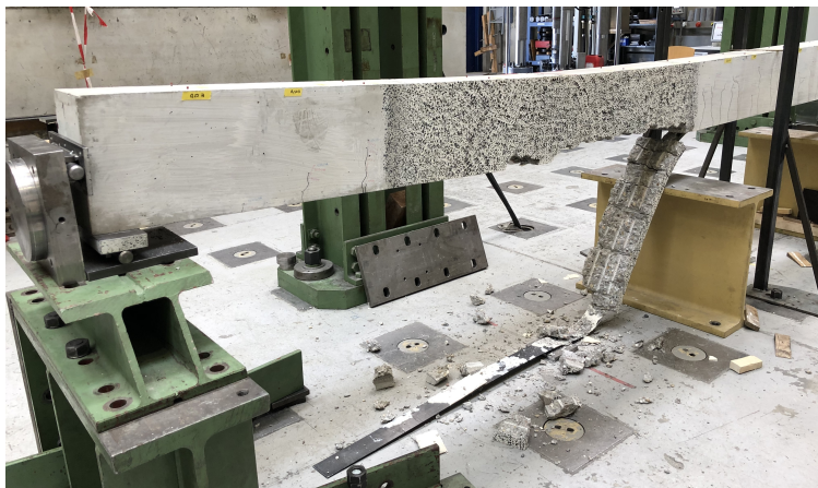
Abb. 6.57: Kohäsionsbruch im Beton bei B01-K4e-B19-C1
