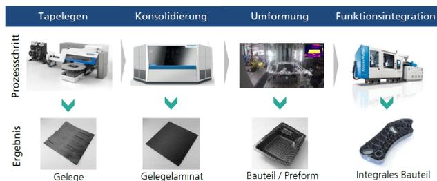
**Abbildung 2.5:** Schematische Darstellung einer sequentiellen Prozesskette [28]
