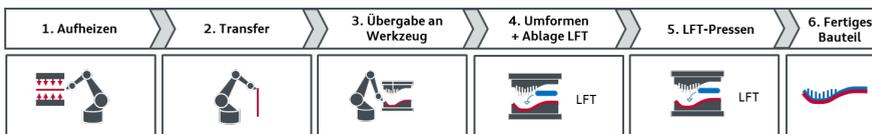
**Abbildung 2.7:** Schematische Prozessdarstellung für eine Funktionalisierung im LFT-Prozess
