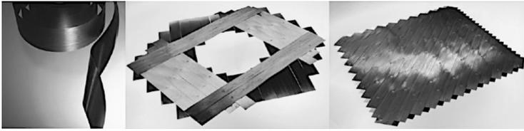
**Abbildung 2.1:** Aufbau eines Geleges bestehend aus UD-Tapes [21]
