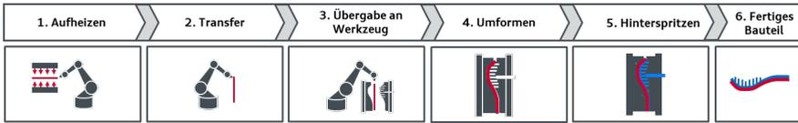
**Abbildung 2.8:** Schematische Prozessdarstellung für eine Funktionalisierung im Spritzgießprozess
