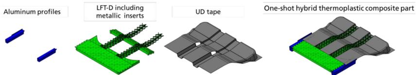
**Abbildung 2.4:** Schematische Darstellung der Herstellung einer Karosseriestruktur aus UD-Tape und LFT [27]
