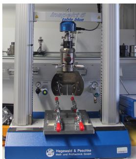
**Abbildung 3.26:** Prüfmaschine mit montierter Prüfvorrichtung
