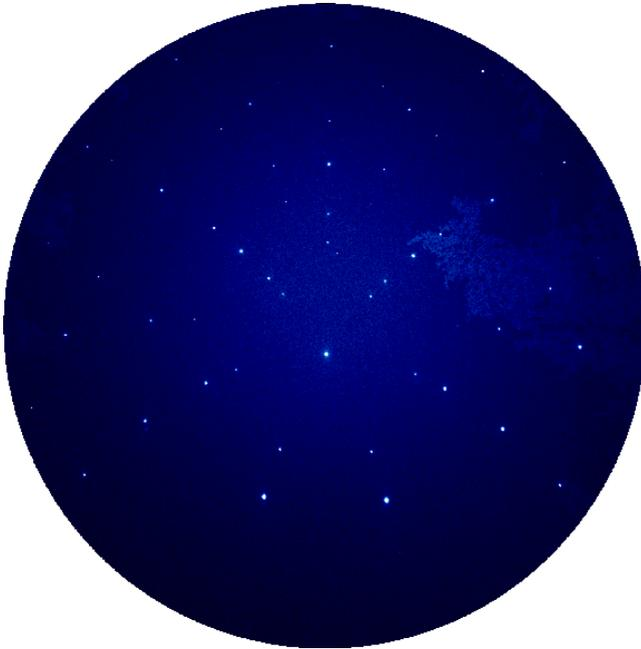
**Abbildung 2.6:** Ein im Rahmen dieser Arbeit an der ESRF (European Synchrotron Radiation Facility, Grenoble, Frankreich) aufgenommenes Beugungsmuster eines Goldkristalls.
