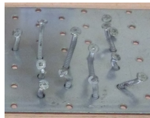
Bild 4-3: Vergleich von Einschlagversuchen von Rillennägeln 4,0 \times 35 \text{ mm} ( links ) und 4,0 \times 50 \text{ mm} ( rechts ).
