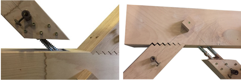
Bild 6-7: Knotenpunkte der Träger VG-1.1 links und VG-1.2 rechts nach Erreichen der Höchstlast.
