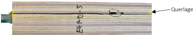
Bild 5-16: Rollschubversagen zwischen Längs- und Querlage im Verankerungsbereich bei einem Prüfkörper der Reihe E4.1.
