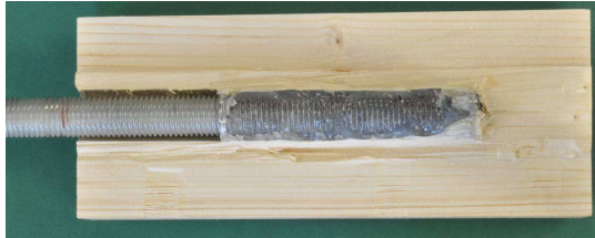
Bild 5-8: Eingeklebte Gewindestange mit zurückversetzter Klebfuge, vgl. [6].
