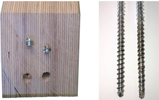
Bild 7-10: Zugstrebe des Prüfkörpers TR-1.1 mit auf Zug versagten Schrauben und der beschädigte Bereich des Schraubengewindes.
