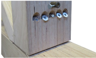
Bild 6-10: Schrauben mit erreichtem Bruchdrehmoment in Träger VG-3.
