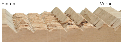
Bild 7-12: Versagensbild der Treppen im Gurtbereich.
