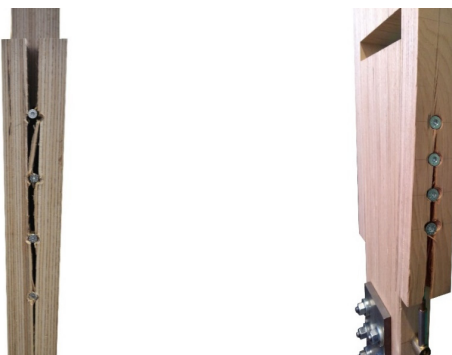
Bild 4-42: Versagte Prüfkörper nach Erreichen der Höchstlast. links: \nu ; \beta = 0^\circ . rechts: \nu ; \beta = 90^\circ .
