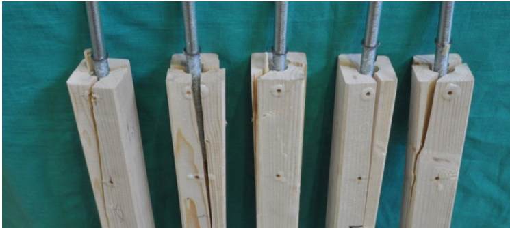
Bild 5-6: Spaltversagen bei Verbindungen mit eingeklebten Gewindestangen in Brettschichtholz aus Fichte, vgl. Enders-Comberg [6].
