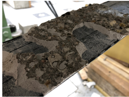
(b) Detail entkoppelte Lamelle
