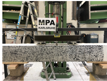
(c) Lasteinleitung Vier-Punkt-Biegeversuch
