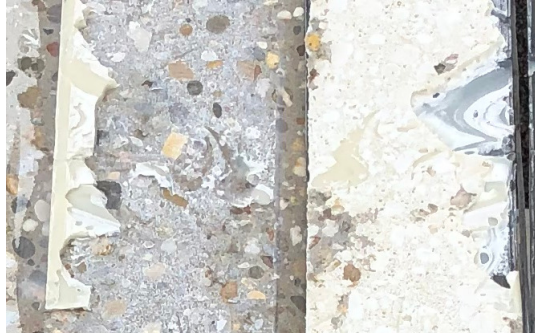
Abb. 6.26: Blasen- und Schlierenbildung durch Lufteinschlüsse eingetragen durch händischen Mischvorgang
