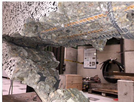
(c) Entkopplungsebene Lamelle
