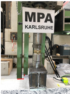
(b) Lasteinleitung Drei-Punkt-Biegeversuch
