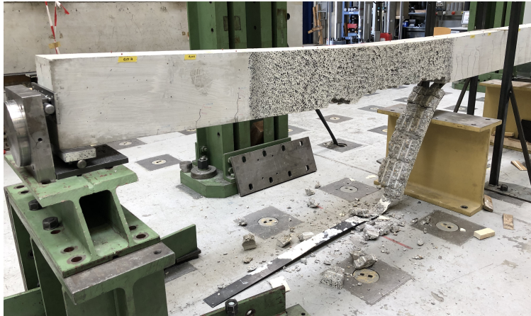
Abb. 6.57: Kohäsionsbruch im Beton bei B01-K4e-B19-C1
